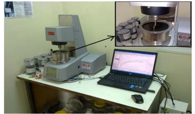
Şekil 1. Karışımların reometre kullanılarak test edilmesi (Testing of the mixtures by using rheometer)
