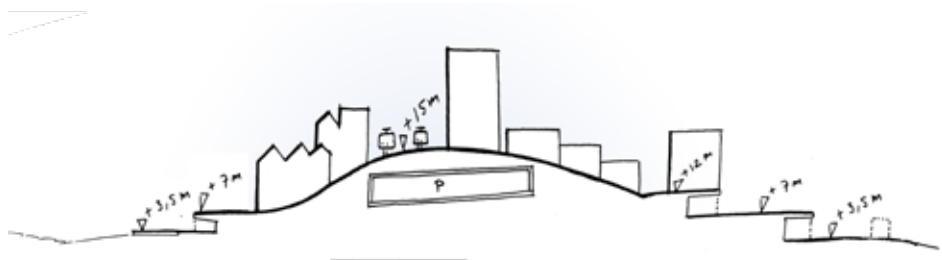
A-A Schematische doorsnede van de nieuwe boulevard bij een nieuw waterwerk van 12 meter hoog
