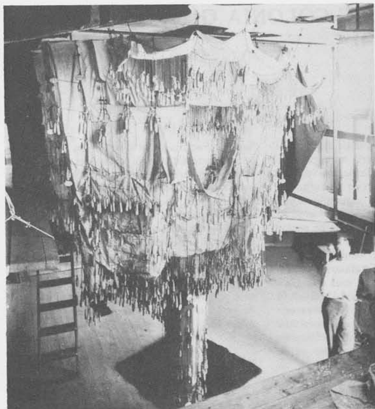
Het definitieve draadmodel voor de kerk. De schaal van de krachten is 1:10.000, die van de lengtematen 1:10. Op de voorgrond valt het voorportaal van de crypte te onderscheiden. (foto: MAS).
