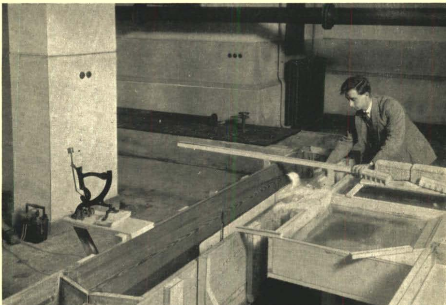
Fig. 2. Model van sluis en groenteveiling.
