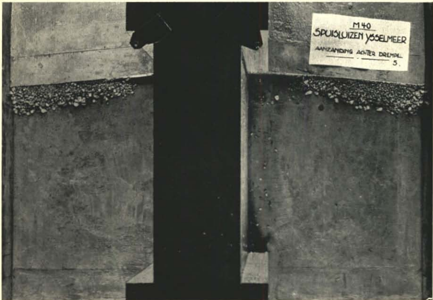
Fig. 9. Neerzetting van zand in Model A.
