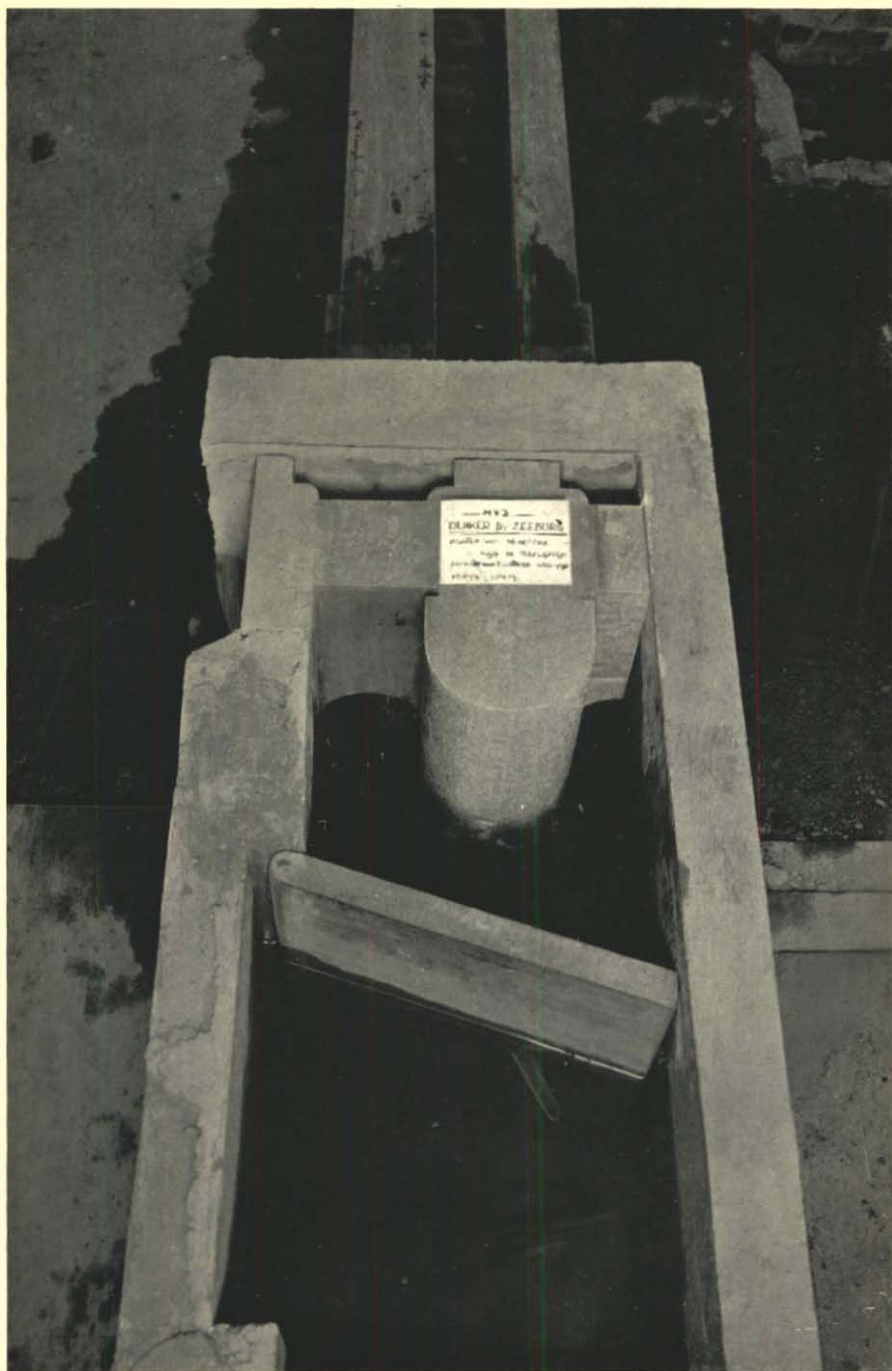
Fig. 5. Bovenhoofd model bij inlaten door toldeuren.
