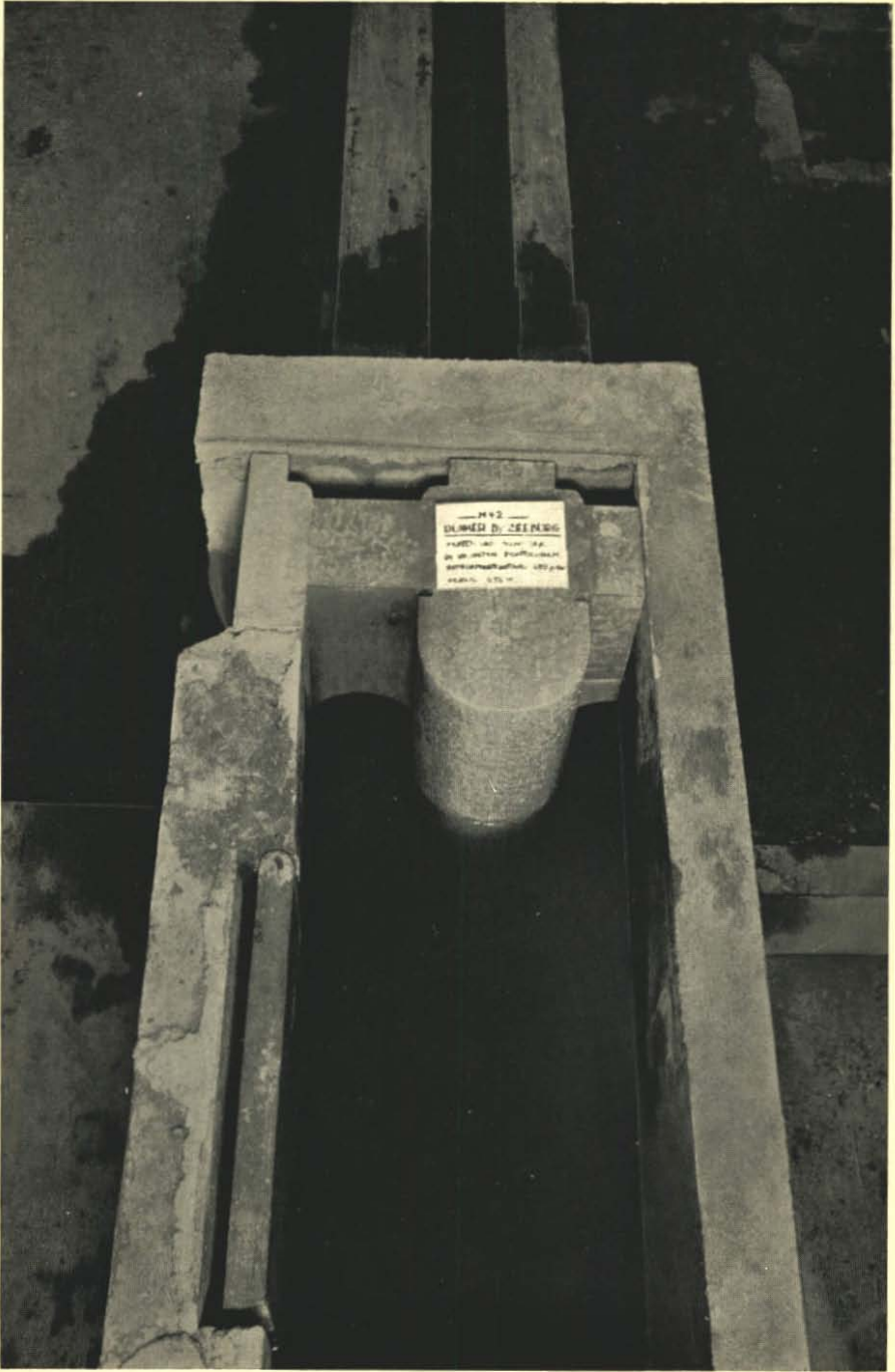
Fig. 6. Bovenhoofd model bij inlaten met open puntdeuren.
