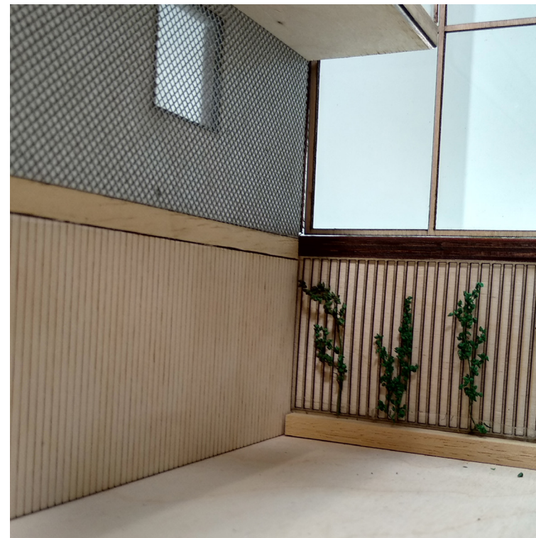
Gevel afwerking met bamboe op de begane grond
