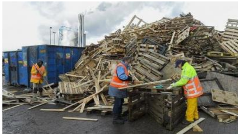
Figure 25; Re-integration dismantling pallets (duurzaamgebouwd.nl)
