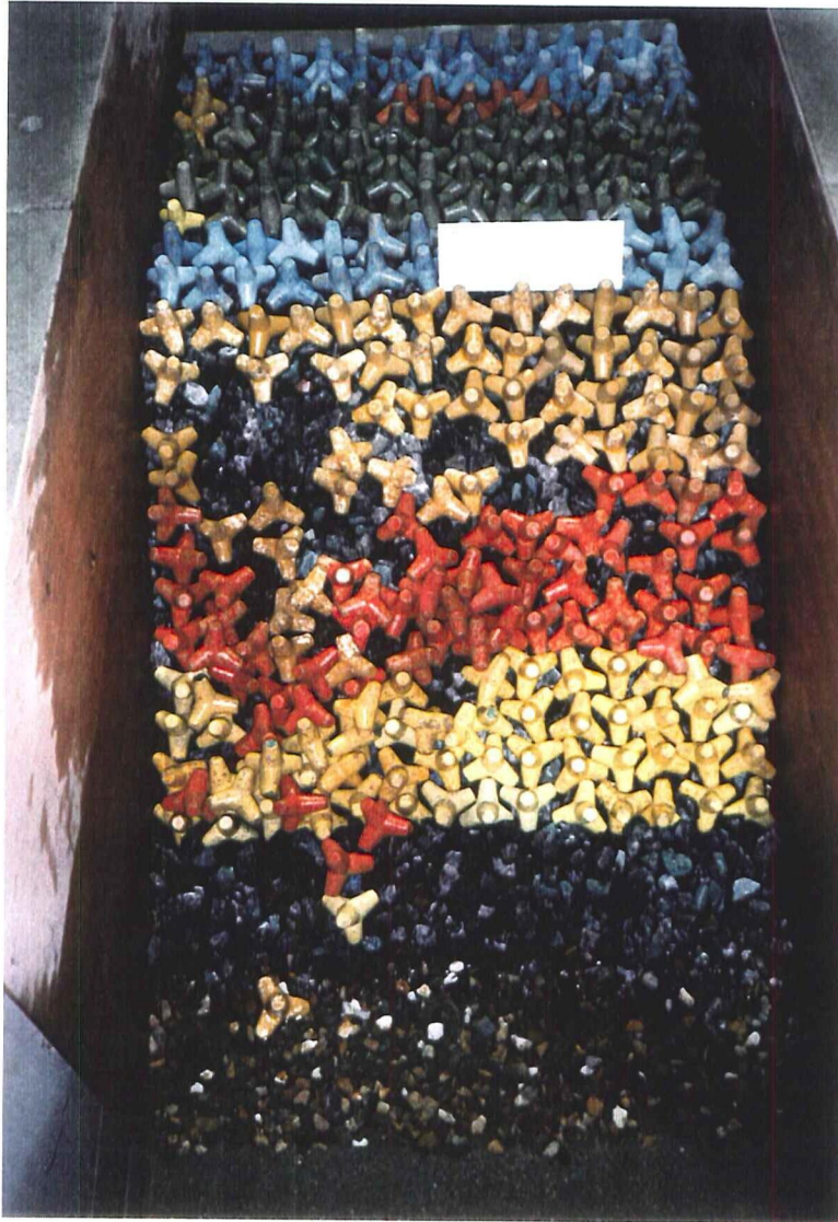
Foto 37 In totaal 14 tetrapoden verplaatst
