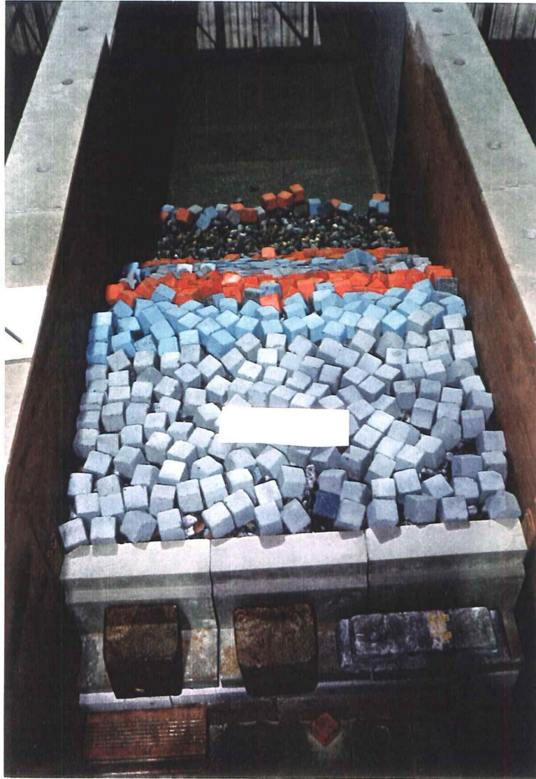
Foto 25 In totaal 26 verplaatste kubussen
