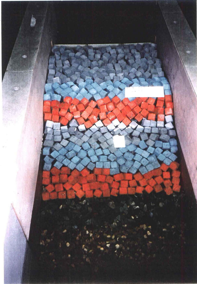
Foto 21 Plaatsing van de kubussen voor P16
