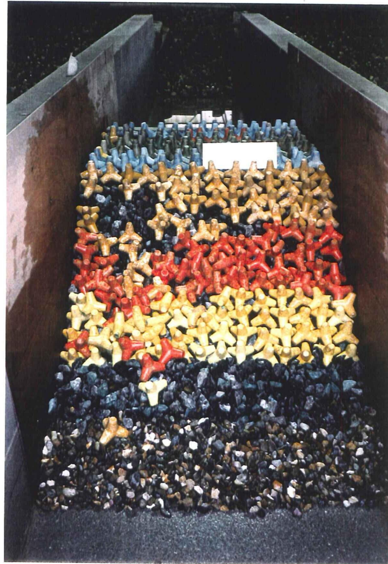
Foto 38 Geen problemen voor het kern- en filtermateriaal
