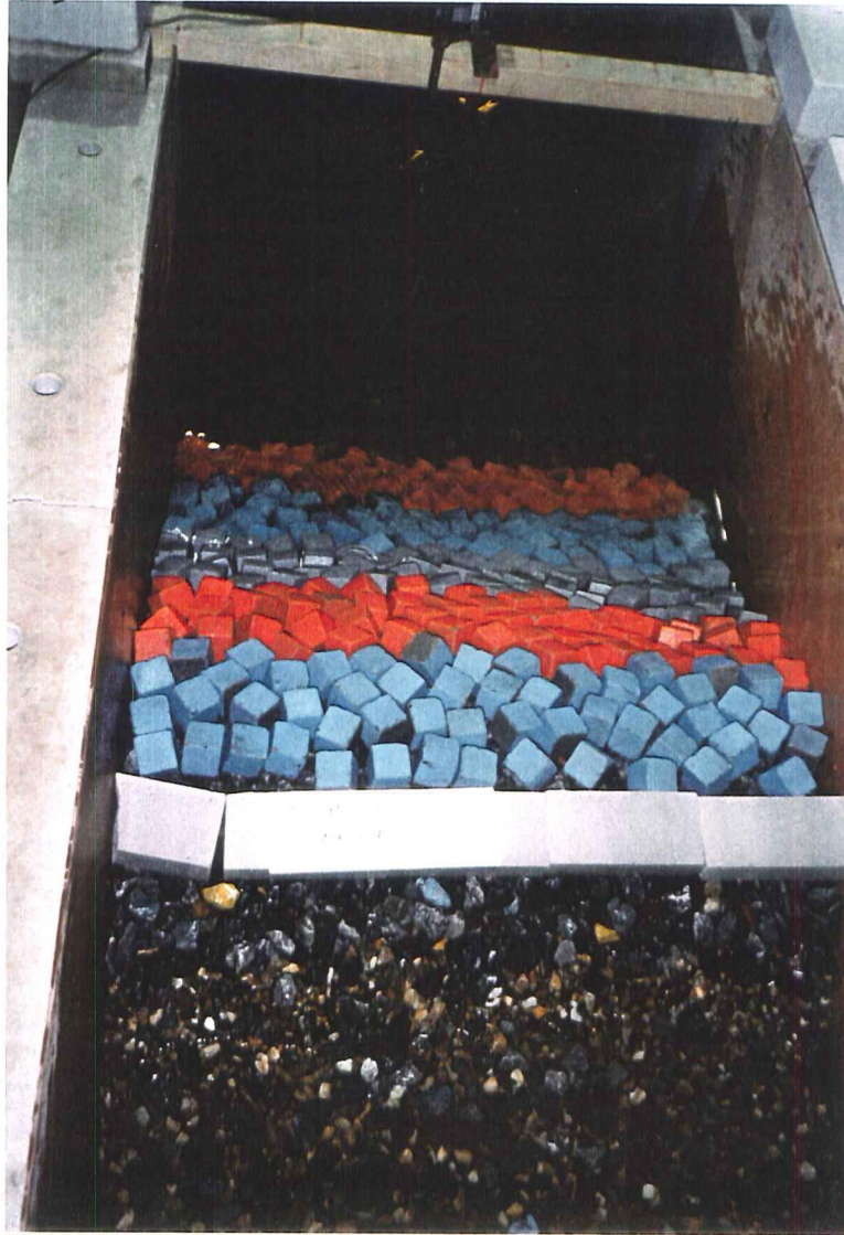
Foto 5 Afvlakking van het achtertalud
