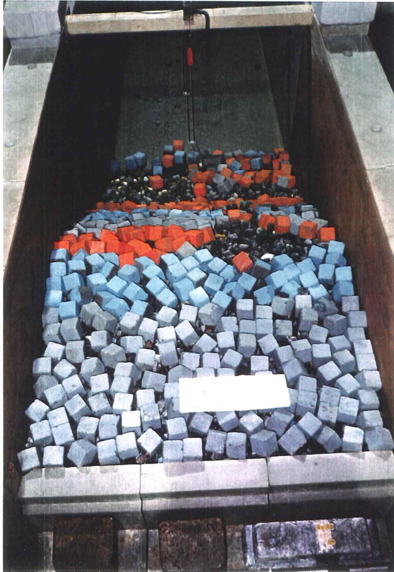
Foto 19 In totaal 57 kubussen verplaatst
