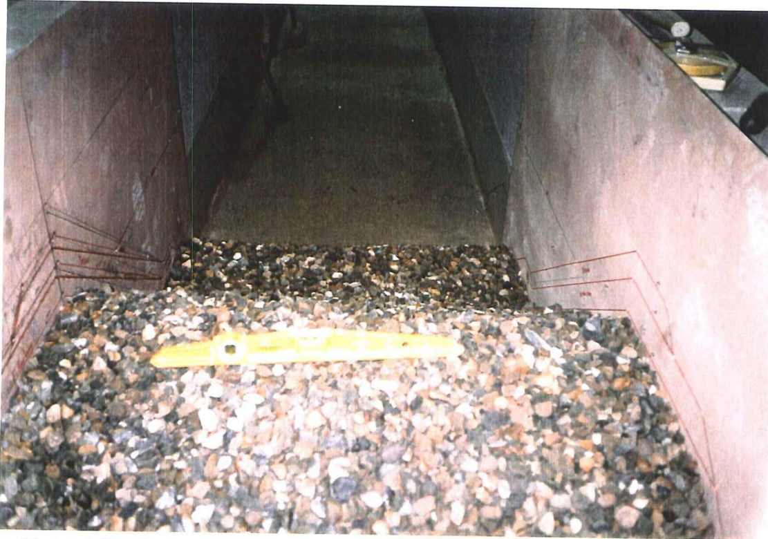
Foto 1 De kern van het model D_{n50} = 0,011\text{m}
