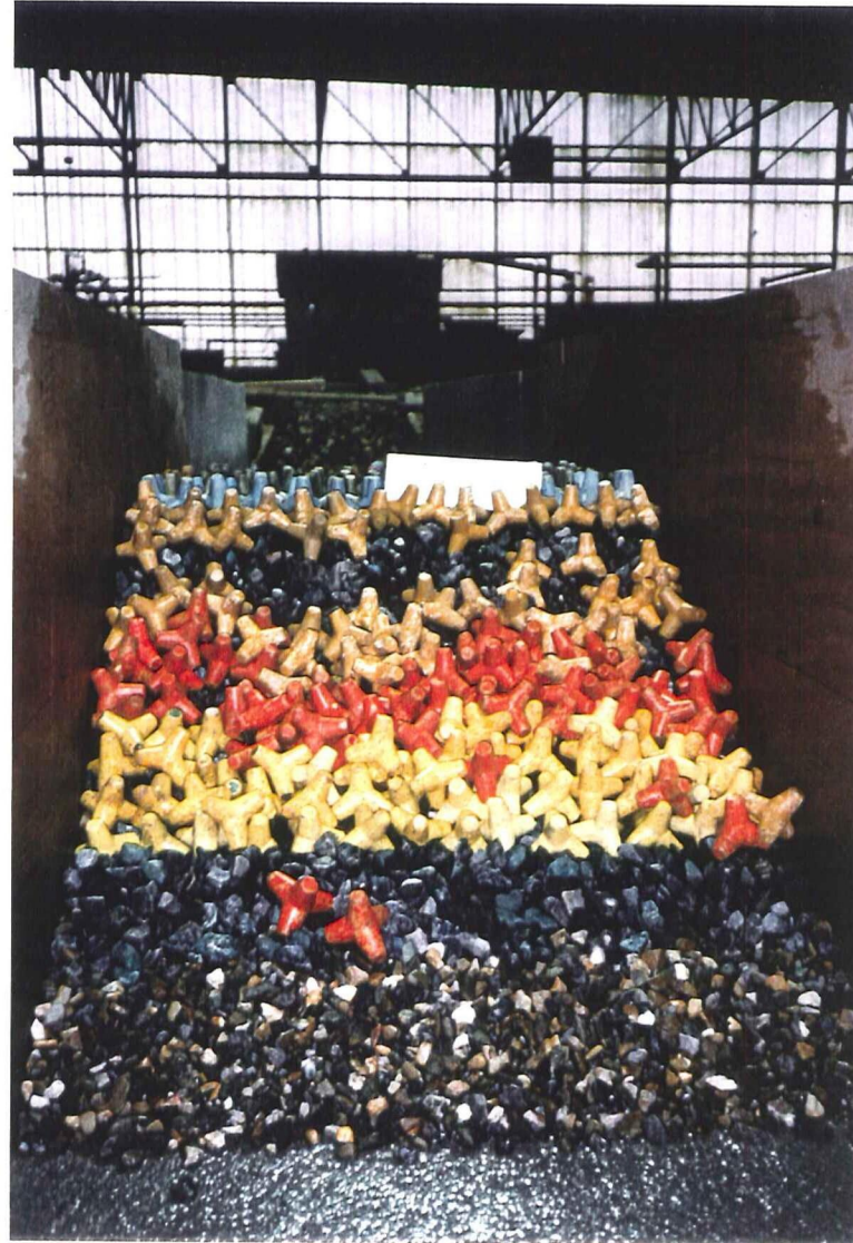
Foto 34 Onderaan de constructie: een stabiele situatie
