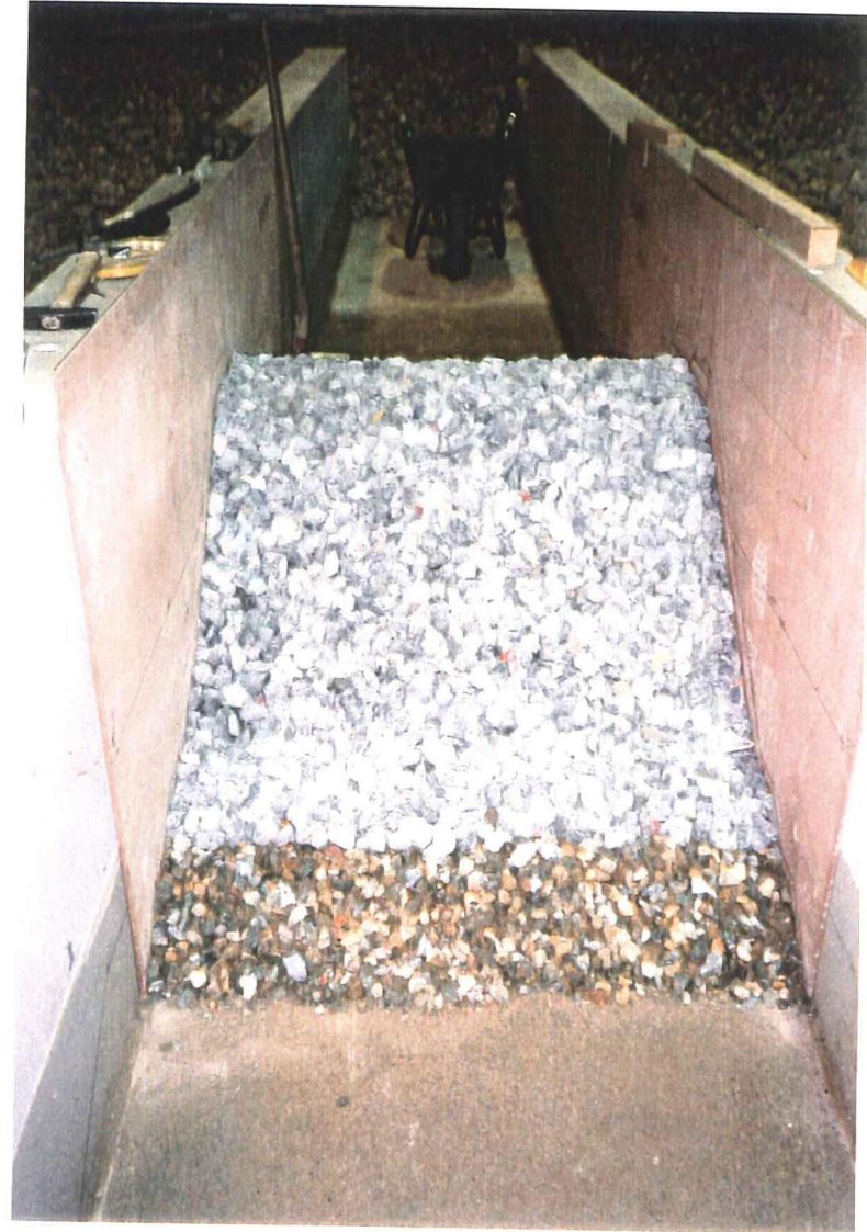
Foto 2 De filterlaag van het model 25 < D_n < 30 \text{ mm}
