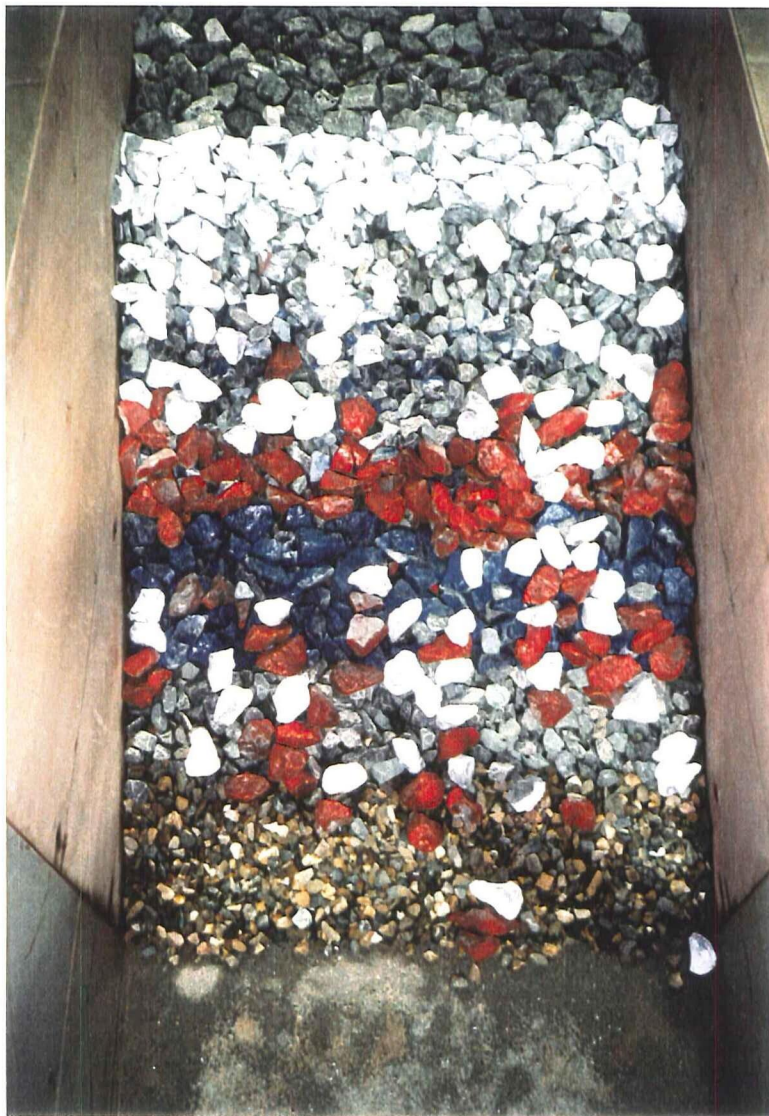
Foto 52 Golfhoogte bij de constructie: 14 cm
