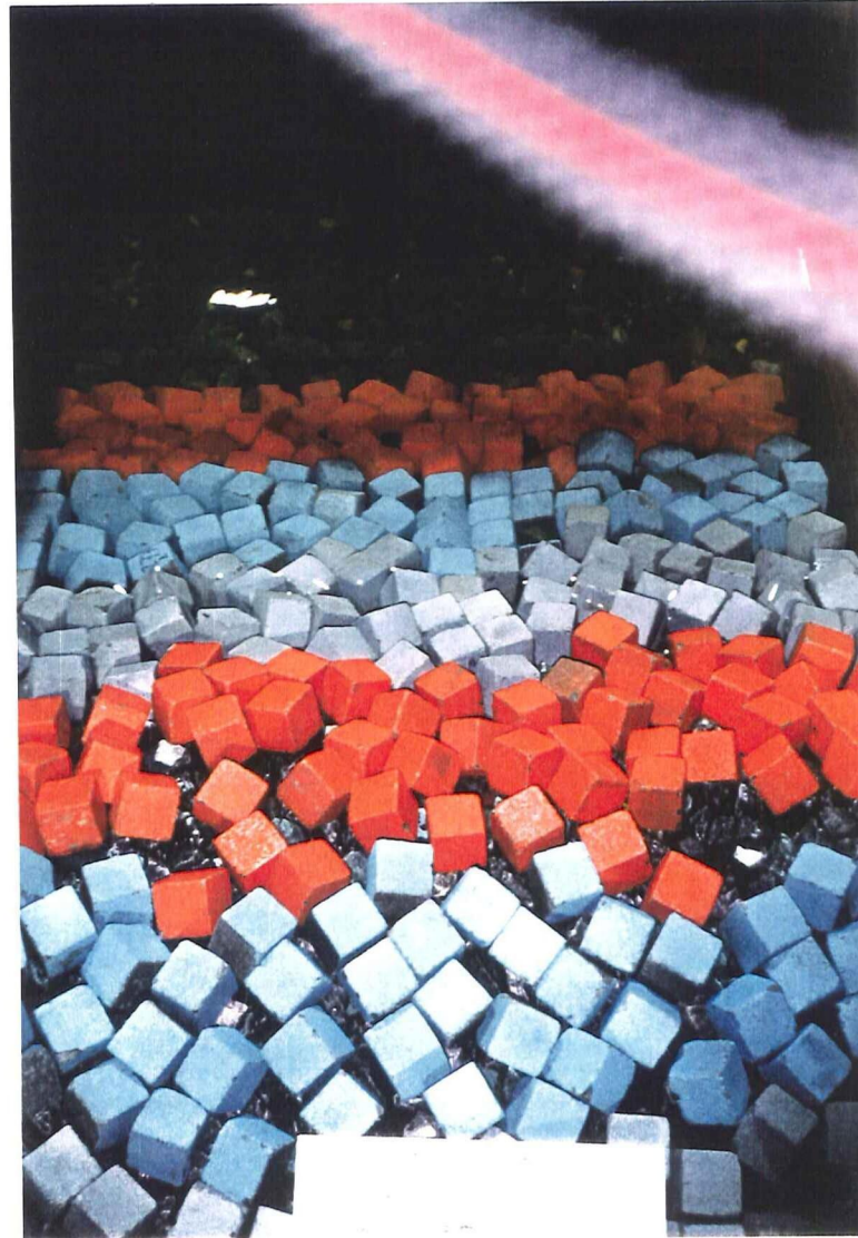
Foto 18 Kubussen in de 4 de laag liggen verspreid
