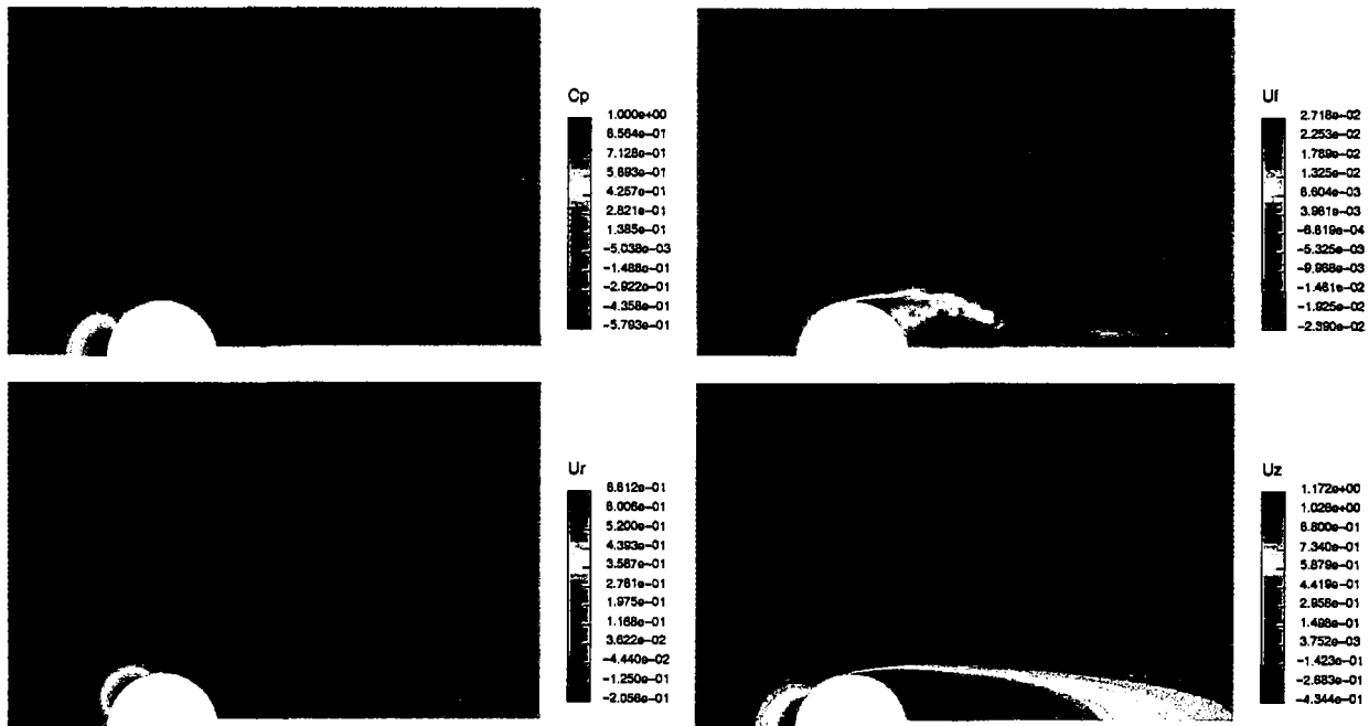
Abbildung 8.14: Zeitgemittelte Felder von Druckbeiwert C_p und den zylindrischen Geschwindigkeitskomponenten \bar{v}_\phi, \bar{v}_r, \bar{v}_z in einer Ebene.
