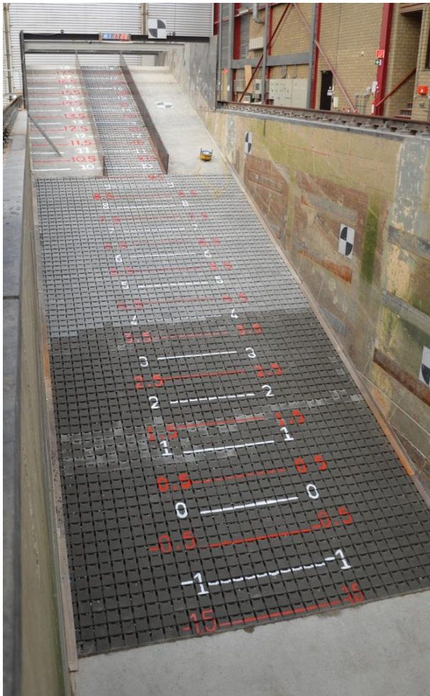
Figuur 3.1 Overzicht van de modelopstelling met RONA®Taille zuilen (voor proef R01).
