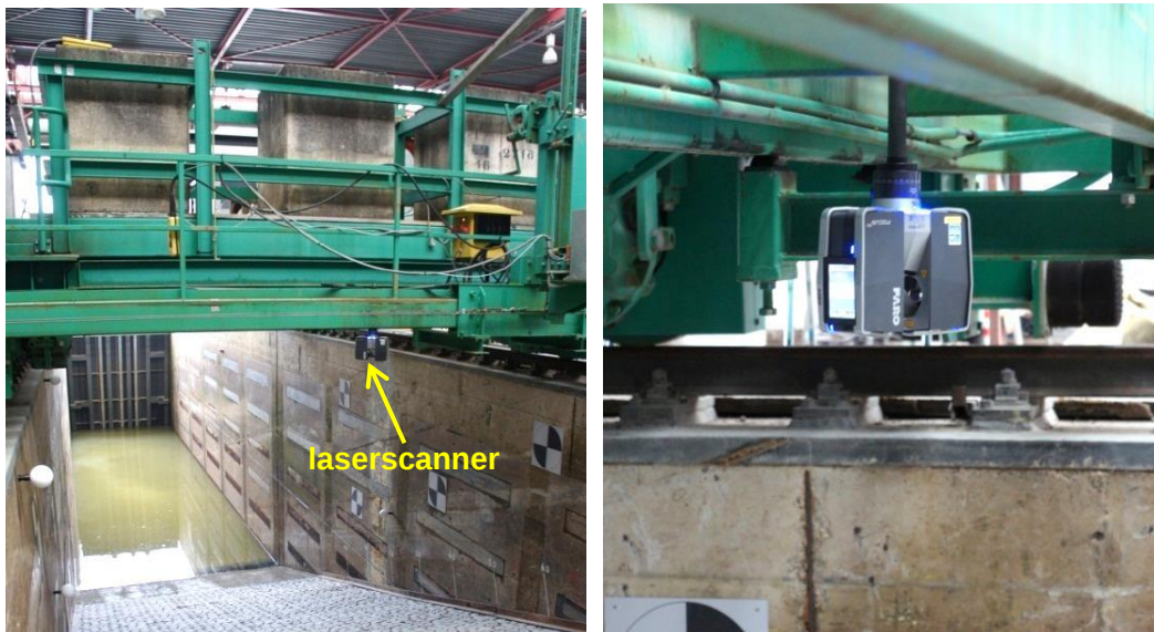
Figuur 3.10 De laserscanner hangt tijdens de meting boven het midden van de goot.
