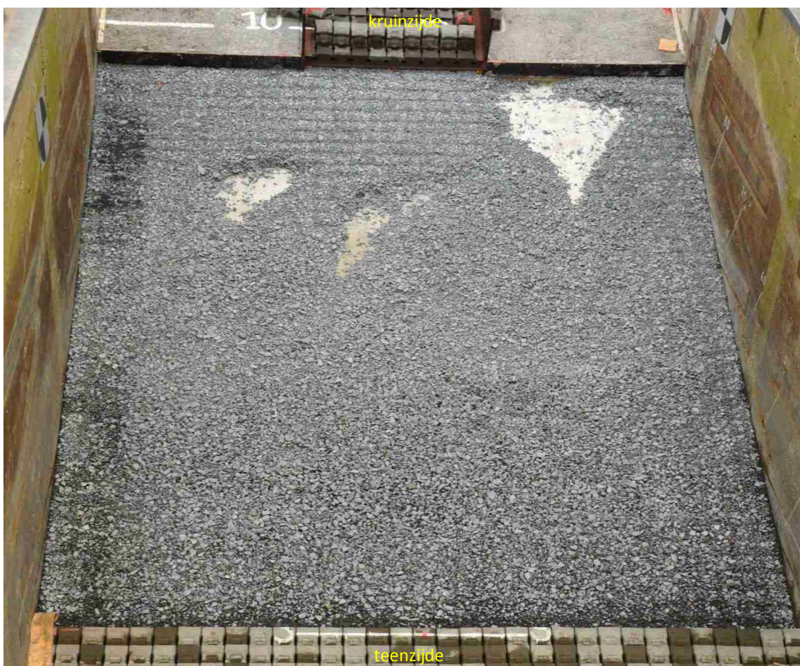
b) de filterlaag na het verwijderen van de zuilen na proef P02 (serie 1-gedraaid). Een deel van het filtermateriaal was van boven de kattenrug gemigreerd naar de kattenrug. Bovenin de testsectie was het inwasmateriaal op een aantal plekken zelfs geheel verdwenen.
