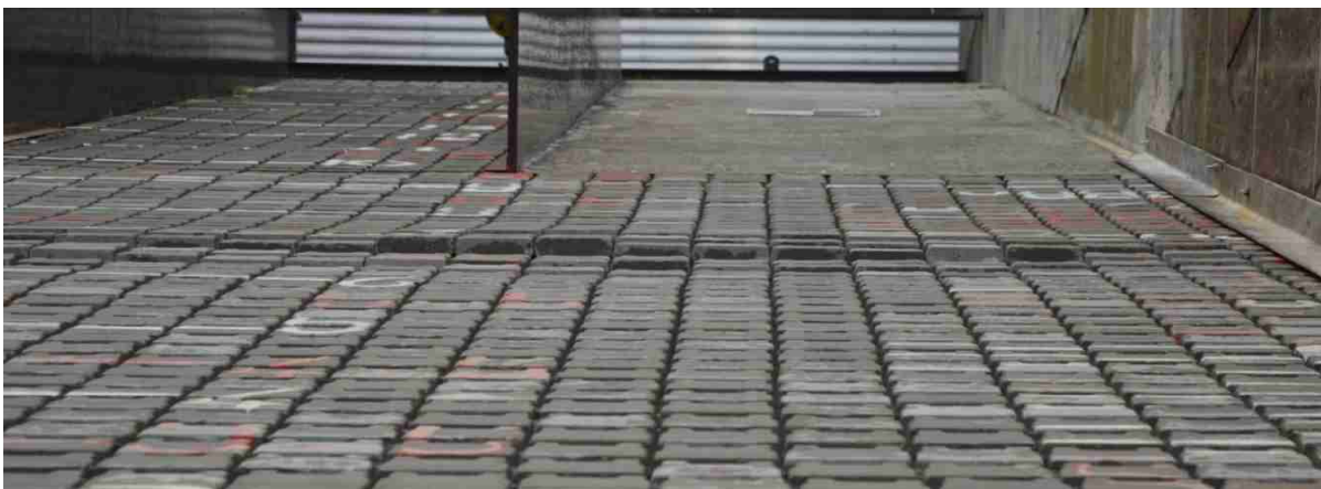
b) vervorming van het talud na proef R13 (serie 3)
