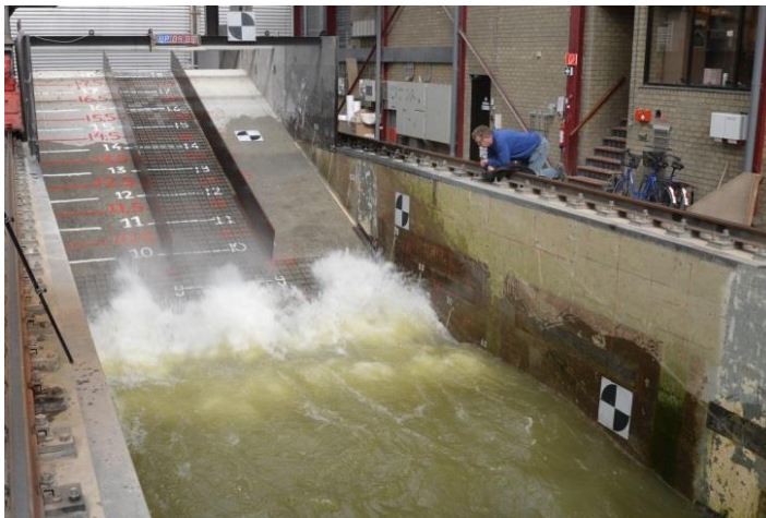
Figuur E.1 Golfaanval op testsectie van RONA®Taille.
