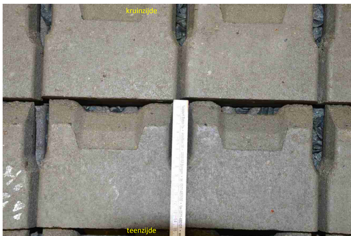
b) doordat van veel zuilen de nokken iets korter waren dan de voet, stonden veel zuilen in de lengterichting van de goot niet met de koppen tegen elkaar (proef R02, serie 1)
