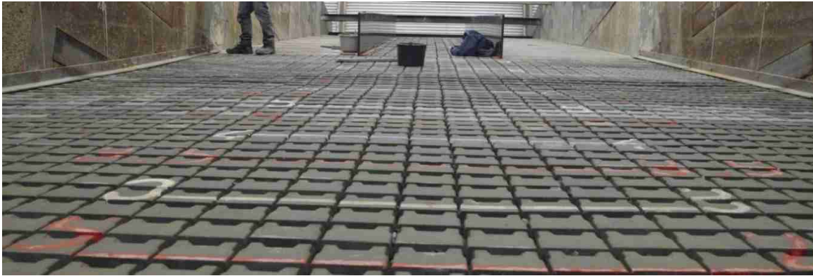
a) het talud voor proef R05 (serie 2) nadat de vervorming van proef R04 zo vlak mogelijk was getrild
