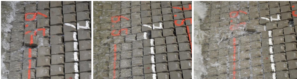
Figuur 4.8 Links: de situatie 1 uur en 36 minuten na het begin van proef R14 (serie 3). Midden en rechts: direct nadat na 1 uur en 50 minuten een zuil uit de bekleding kwam, zijn een teenwaarts gelegen zuil en enkele kruinwaarts gelegen zuilen gekanteld en/of in het ontstane gat naar beneden geschoven (proef R14, serie 3).
