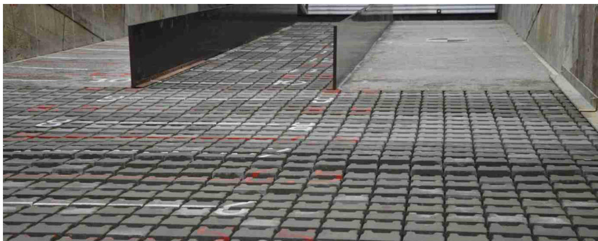
b) vervorming van het talud na proef R04 (serie 2)
