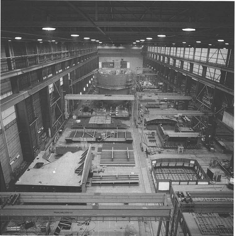
Figuur 2.10 Schip in aanbouw op de helling (Bron: IHC Holland, Sliedrecht)
