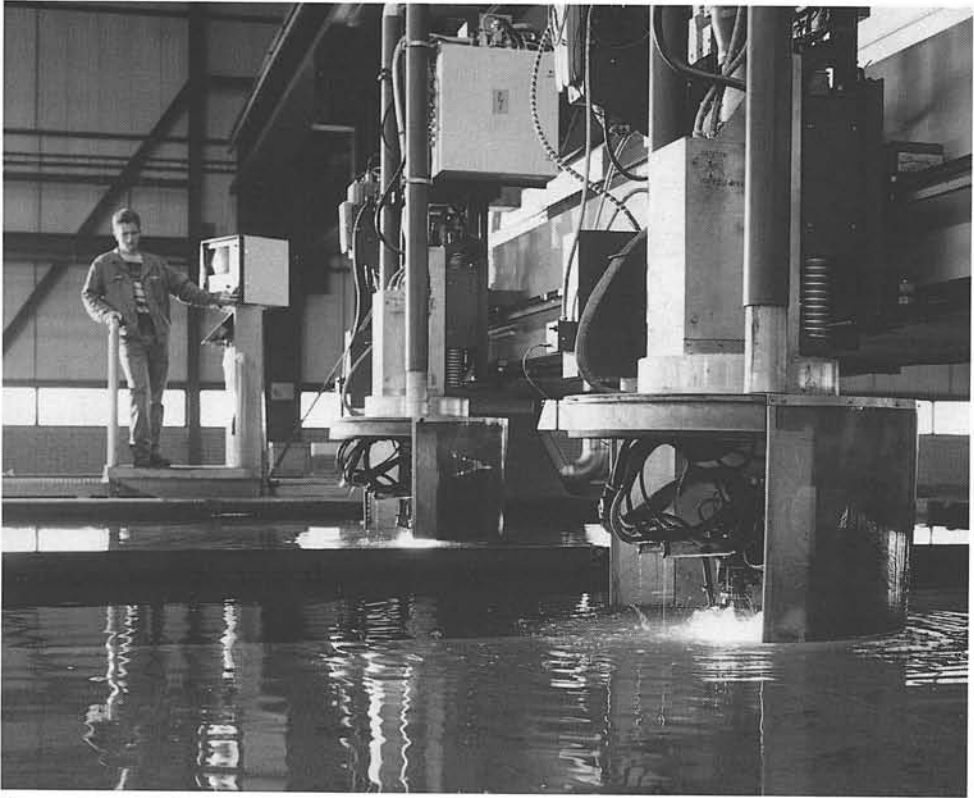
Figuur 7.24 Plasma snijden bij Centraalstaal B.V.
