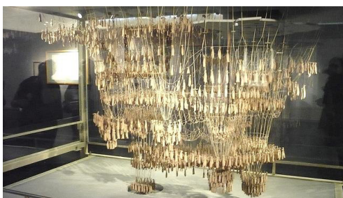
Figure 6. String and Weights Model of the Sagrada Família. Antoni Gaudi.
