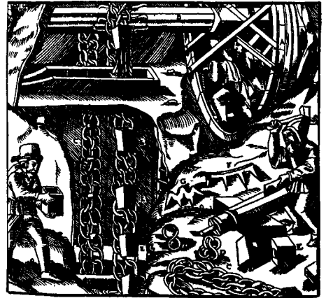
Das Tretrad A. Die Welle B. Die doppelte Kette C. Ein Glied der doppelten Kette D. Die Kettten E. Eine einfache Klammer F. Eine dreimal gekrümmte Klammer G.
