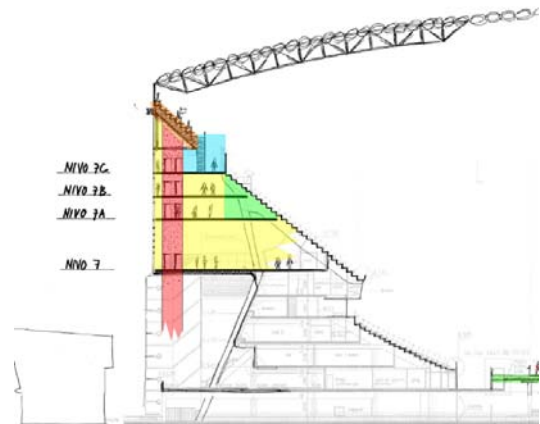
afb. 1.04 Uitbreiding nieuw bouwdeel en nieuw dak
