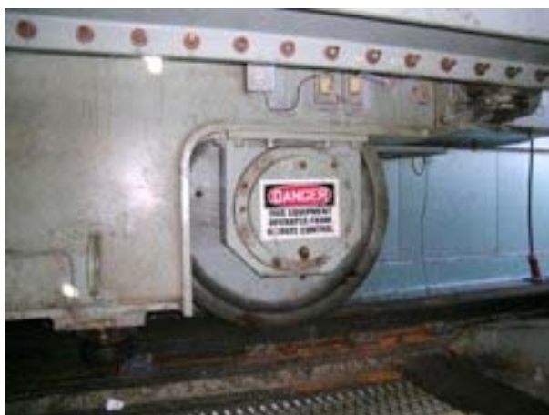
afb. 2.5 Een deel van één van de tien tweewielige onderstellen is vervangen
