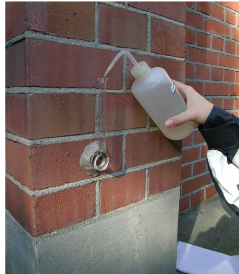
FIG. 4.20 Karsten Tube test / Photo: R. van Hees
