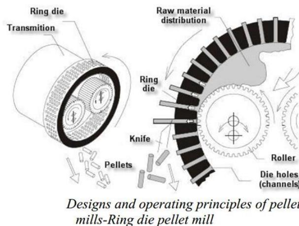
**Figure 4.** Rotating die pellet mill<sup>1</sup>
