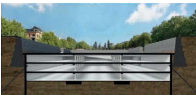
FEBRUARI 2019 | uitgraven in stross grondbanketten | starten betonwanden kopse kanten | starten trappenhuizen niveau -1
