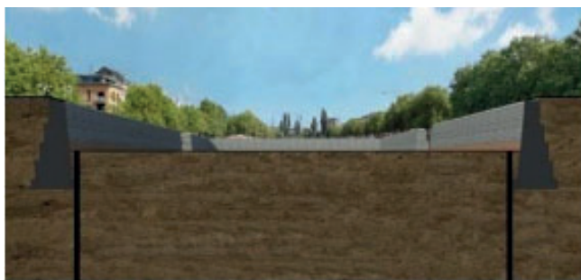
SEPTEMBER 2018 | uitgraven tot vloerplaat niveau -1 | afbraak dokmuren ter hoogte van trappenhuizen | plaatsen sifwanden | diepbemaling bouwput
