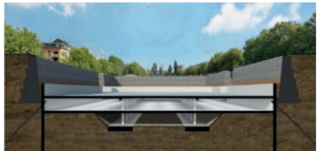
JANUARI 2019 | aanbrengen kolommen niveau -4, -3, -2 | aanbrengen balken niveau -4, -3, -2 | aanbrengen vloerplaat niveau -4, -3, -2
