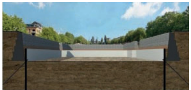
NOVEMBER 2018 | uitgraven tot onderkant ankers | plaatsen ankers
