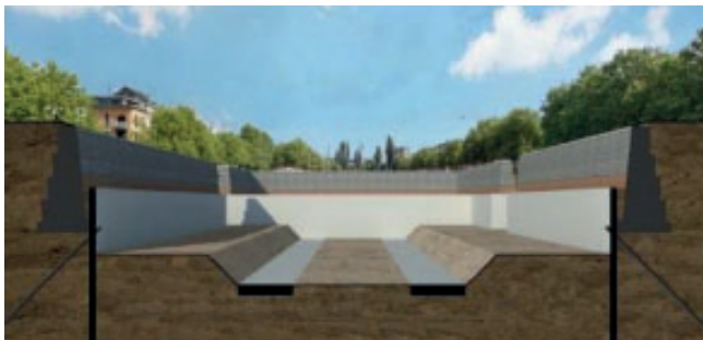
DECEMBER 2018 | uitgraven tot funderingsplaat | aanbrengen funderingszolen
