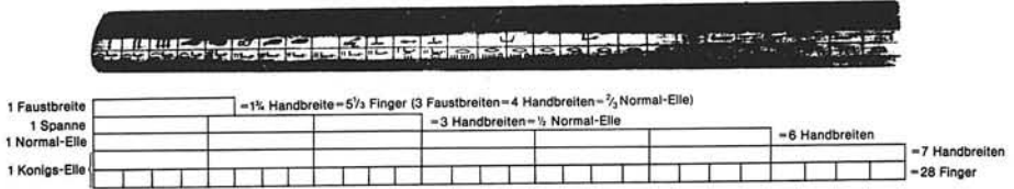
Figuur 6.1: De vroegst bekende meetlat: de el van Amenemope uit 1250 voor Christus (Braunfels et al. (1973).
