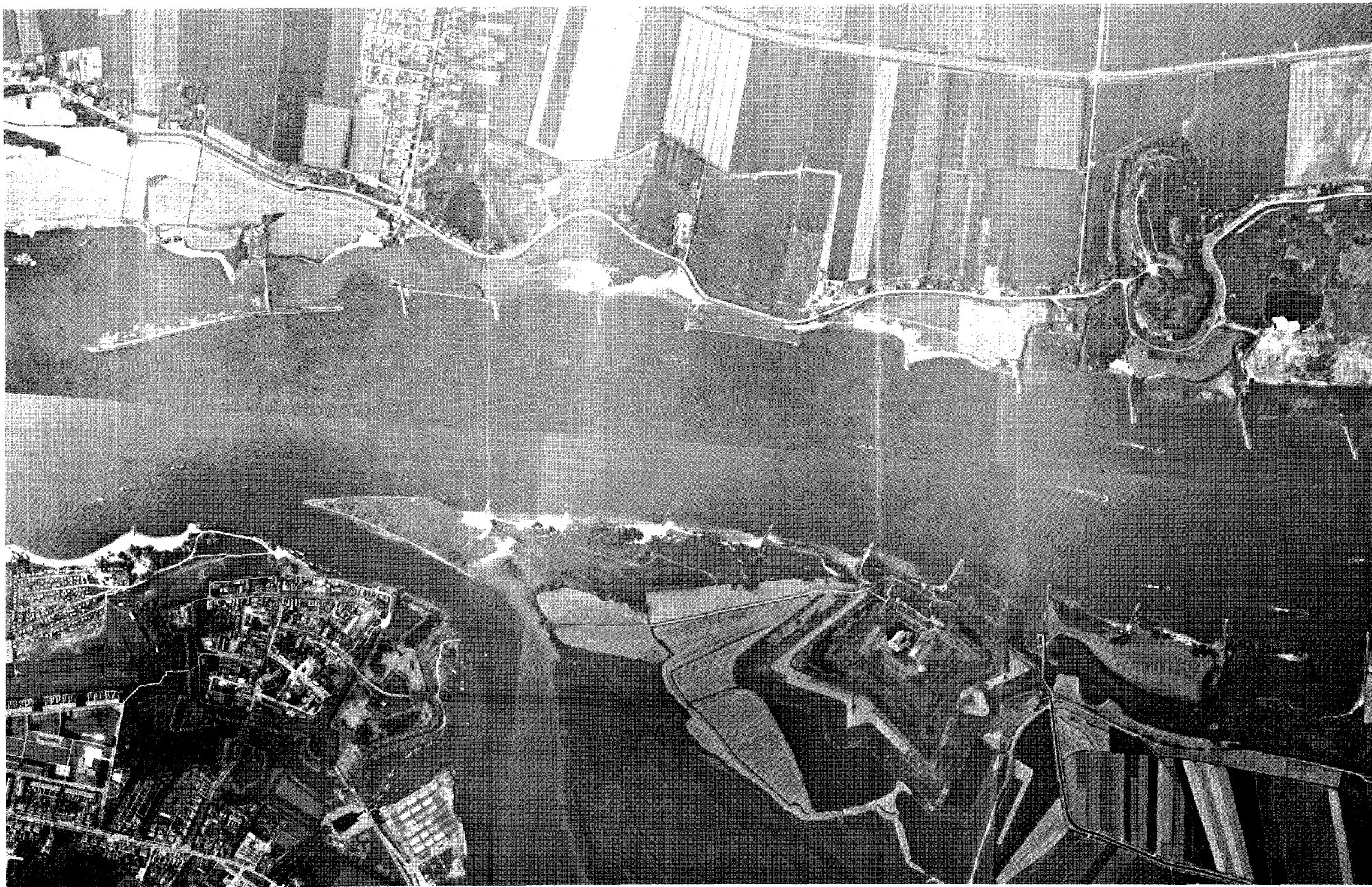
fig. 18 Fotomontage schaal 1:10.000 (fotografische verkleining uit opnameschaal 1:5000); opnamedatum 14-6-1968, camera R.C.5a, F= 152.15. zie ook fig. 19 - kaartfragment rivierkaart „nieuwe stijl”, nr. 125.
