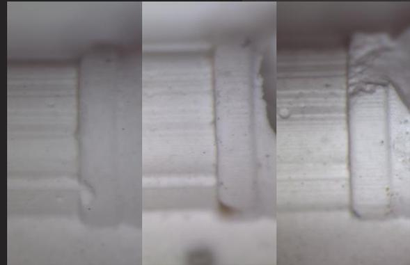
Figure XX: Left to right quartz/plaster ratio: (0,25/0,75) | (0,5/0,5) | (0,75/0,25)
