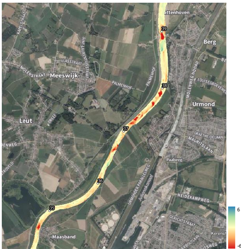
Figuur B.3.1.1: Bodemhoogteverandering tussen rkm 34 en 39 op de Grensmaas. De erosiekuilen hebben dieptes tot meer dan 10 m.
