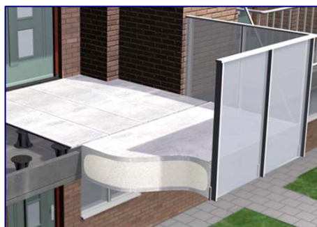
Figuur 0-3 Verlenging met microbeton
