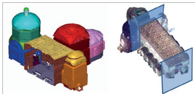
Figura 7. Porzioni di modelli 3D (mesh e nuvola) interni alla chiesa, con identificazione a destra dei settori che presentano criticità elevate di stabilità (ribaltamento della facciata e distacco del corpo absidale dalla navata).
