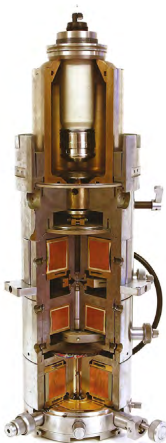
Figuur 2 | Opengewerkte elektronenmicroscoop.
