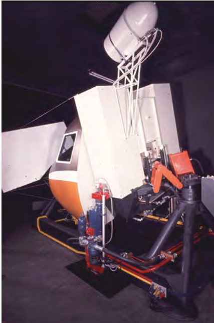
Figuur 1 | Vluchtsimulator met Fokker F-27 cockpit en hydrostatisch gelagerde servomotoren voor het 3-DOF bewegingssysteem (1969).
