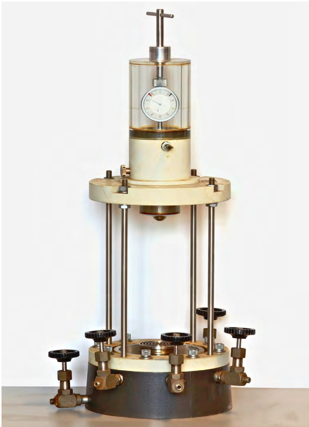
Figuur 5 | Triaxiaal apparaat van het TNO.
