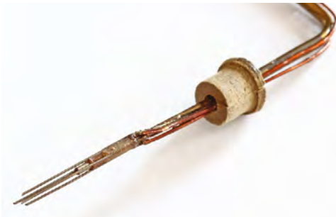
Figuur 2 | Kruisdraadprobe uit de jaren '60.
