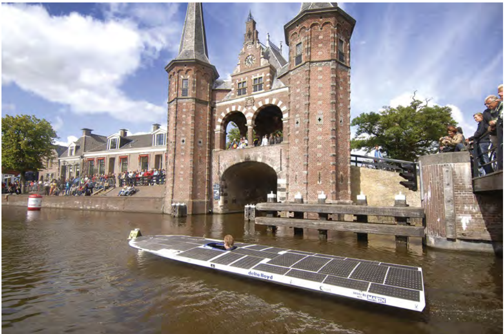
Figuur 3 | Solar Boat #3, de eerste Delftse zonneboot op draagvleugels, voor de Sneker Poort in Bolsward in 2008. Door de lokaal voorgeschreven snelheidsbeperking kon de zonneboot het vliegen op haar onderwatervleugels hier niet demonstreren.
