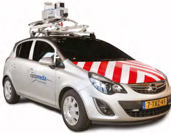
Figuur 3 | De CycloMedia auto met het DCR10 systeem op het dak.
