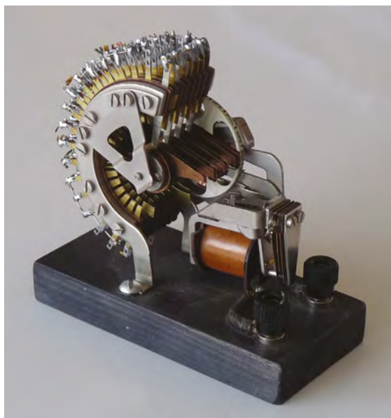
Figuur 2 | Testudo stappenschakelaar, welke werd geactiveerd door een relais rechtsonder.
