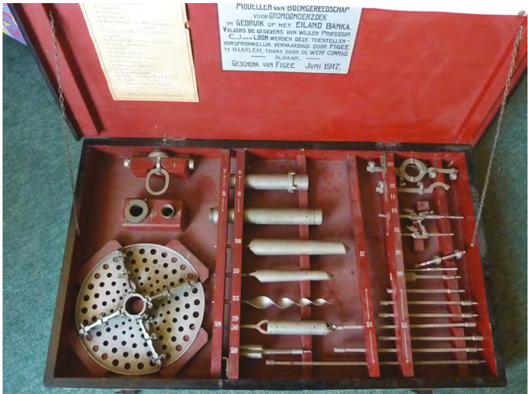
Figuur 4 | Miniatuur model van Banka-boor, geschenken in 1917 door de Firma Figee.
