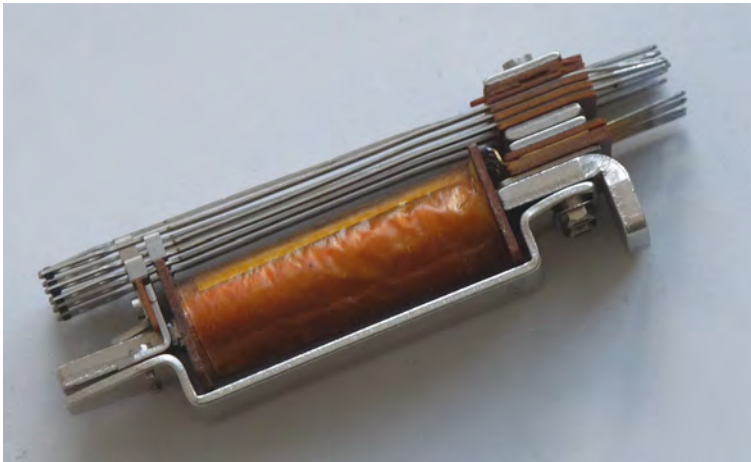
Figuur 1 | Een plaatanker relais, een van de ruwweg duizend exemplaren in de Testudo.
