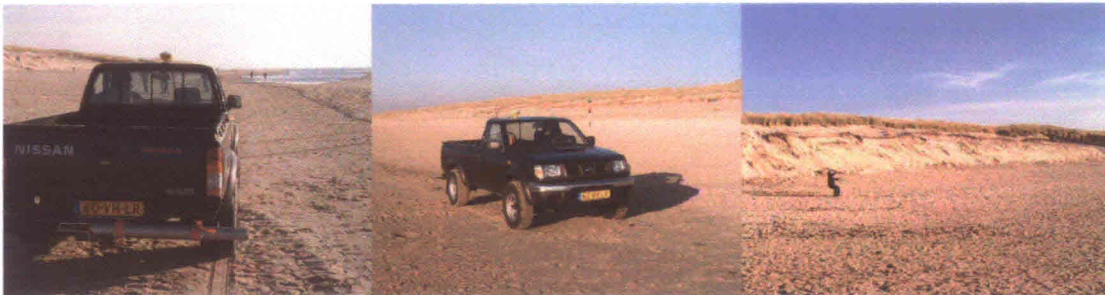
figuur 8: Impressie van de meting op het strand, met de MEDUSA detector gemonteerd op een 4WD. De rechter foto laat duidelijk de scherpe duinovergang na de storm zien.
