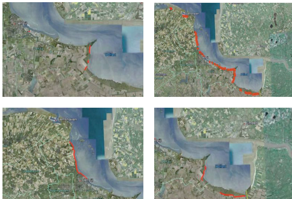
Afbeelding 8 - Afgekeurde dijken Eems-Dollard: op hoogte (linksboven), op de bekleding (rechtsboven) en op geotechnische stabiliteit (links- en rechtsonder)
