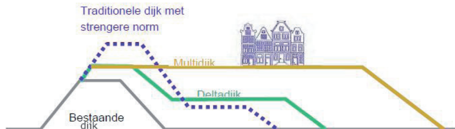
Afbeelding 14 - Kenmerken verschillen en overeenkomsten tussen een Deltadijk en een Multidijk (Van Loon-Steensma et al., 2012a)
