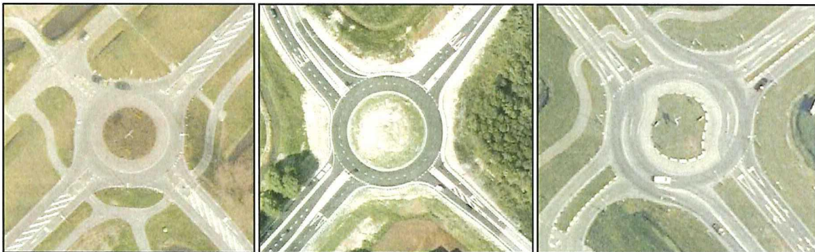
Figuur 1-1: Links een enkelstrooks rotonde, midden een tweestrooks rotonde en rechts een turborotonde
