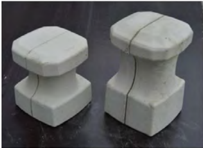
Figuur 4.3 Impressie van eerder geteste zetstenen (links: Testblok, rechts Hillblock zoals getest in 2014)
