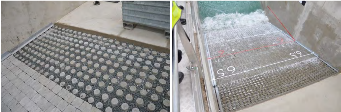
Foto 3.1 Links: Impressie Grassblocks na inwassen voorafgaande aan Test P01. Rechts: tijdens Test P01
