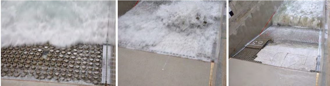
Foto 3.3 Schadeverloop Grassblocks tijdens Sub-test P04 (links: enkele Grassblocks zijn uit het talud gelicht. Midden: een groot deel van de Grassblocks bezwijkt. De Drainageblocks komen vrij te liggen. Rechts: De Drainageblocks zijn bezweken doordat de Grassblocks zijn bezweken.
