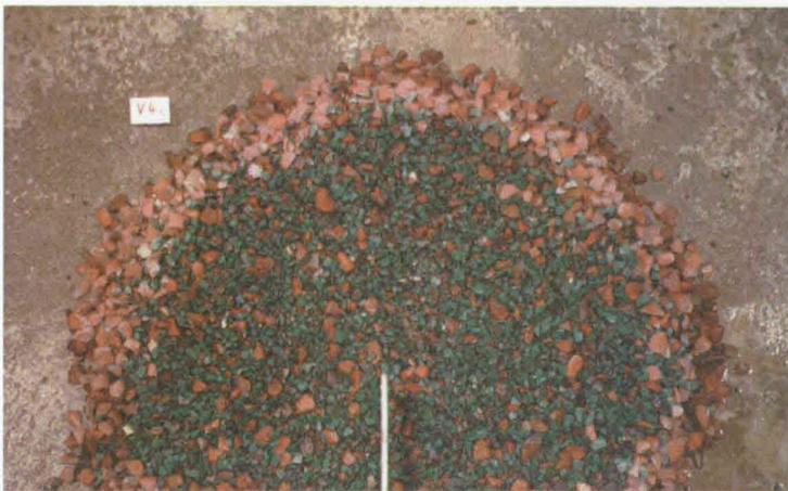
Abb. 3.2: Horizontaler Schnitt bei 10 cm Höhe durch eine Böschung der Mischung M I
