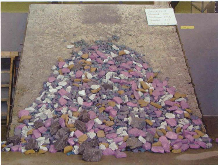
Abb. 4.1: Beispiel für die geschüttete Böschung im Modell nach der Entleerung des Versuchsbeckens, Versuch 44.
