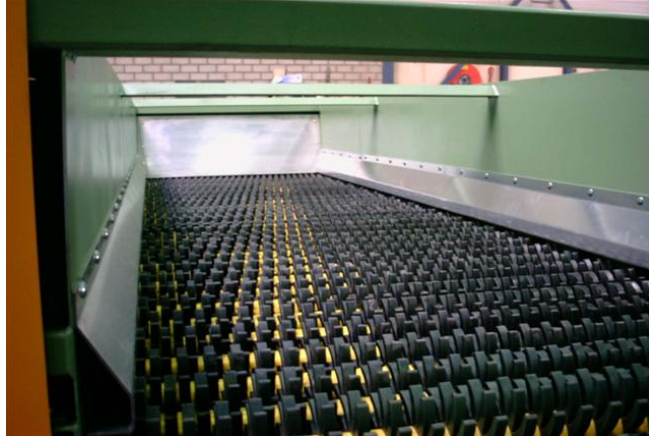
Figuur 5.2: Binnenkant sterrenzeef („Sterrenzeef - Konings Transportbanden”, 2022)
