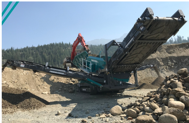
Figuur 5.3: Schudzeef („Powerscreen Warrior 1800 Scalping Screen”, g.d.)
