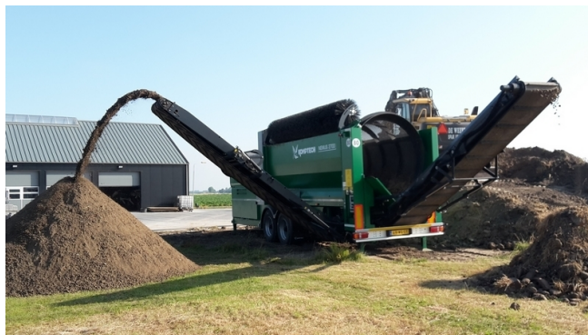
Figuur 5.1: Mobile trommelzeef („Mechielsen machineverhuur”, g.d.)
