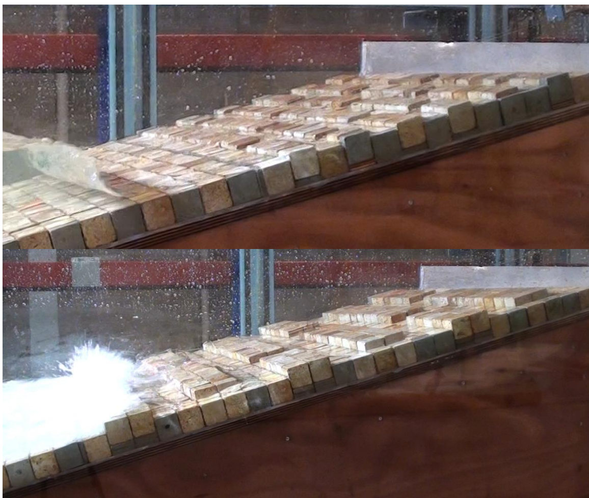
Figuur 2.4: Proevenserie ribbenpatroon schaal 1:22 (boven) en schaal 1:11 (onder)
