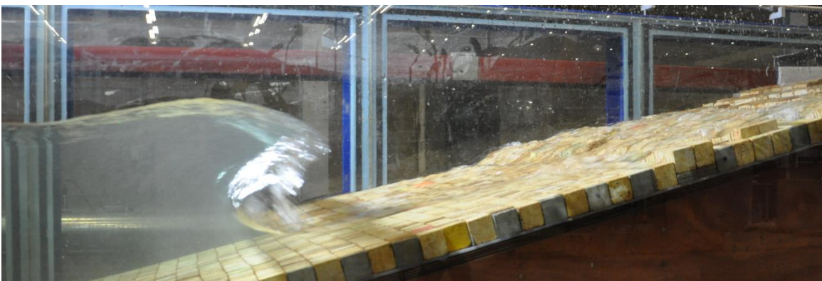
Figuur 4.23: Inkomende golf tijdens de schaalproeftesten. Het water op het talud is nog niet volledig weggestroomd door onder andere onvoldoende drainage op het moment dat de nieuwe golf er weer aankomt.
