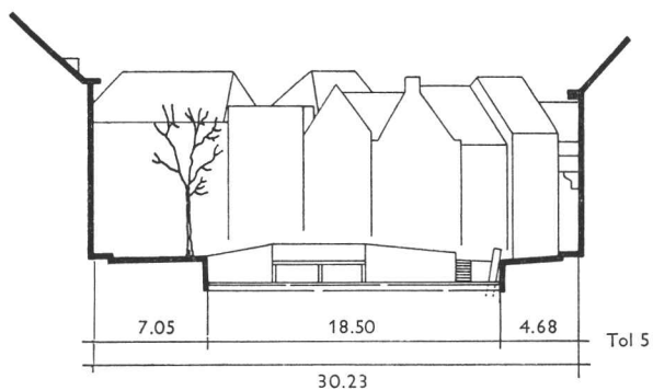
Figuur 8 – Dwarsprofielen over de Oude Haven, de Haven en de Voorhaven te Schoonhoven, schaal 1:500. Maten in meters.
