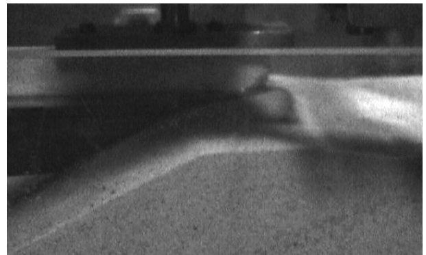
Centrifugeproef van een aanvaring tussen een schip en een zandlichaam, uitgevoerd door de TU Delft
