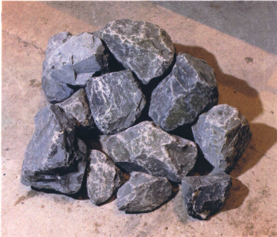
8. filterstenen met een diameter van ongeveer 150 mm
