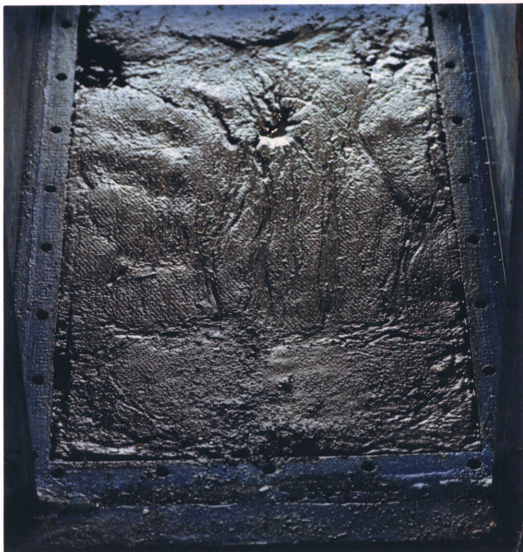
10. opgetreden erosie tijdens proef 501 zonder vooraf gemaakte geul
