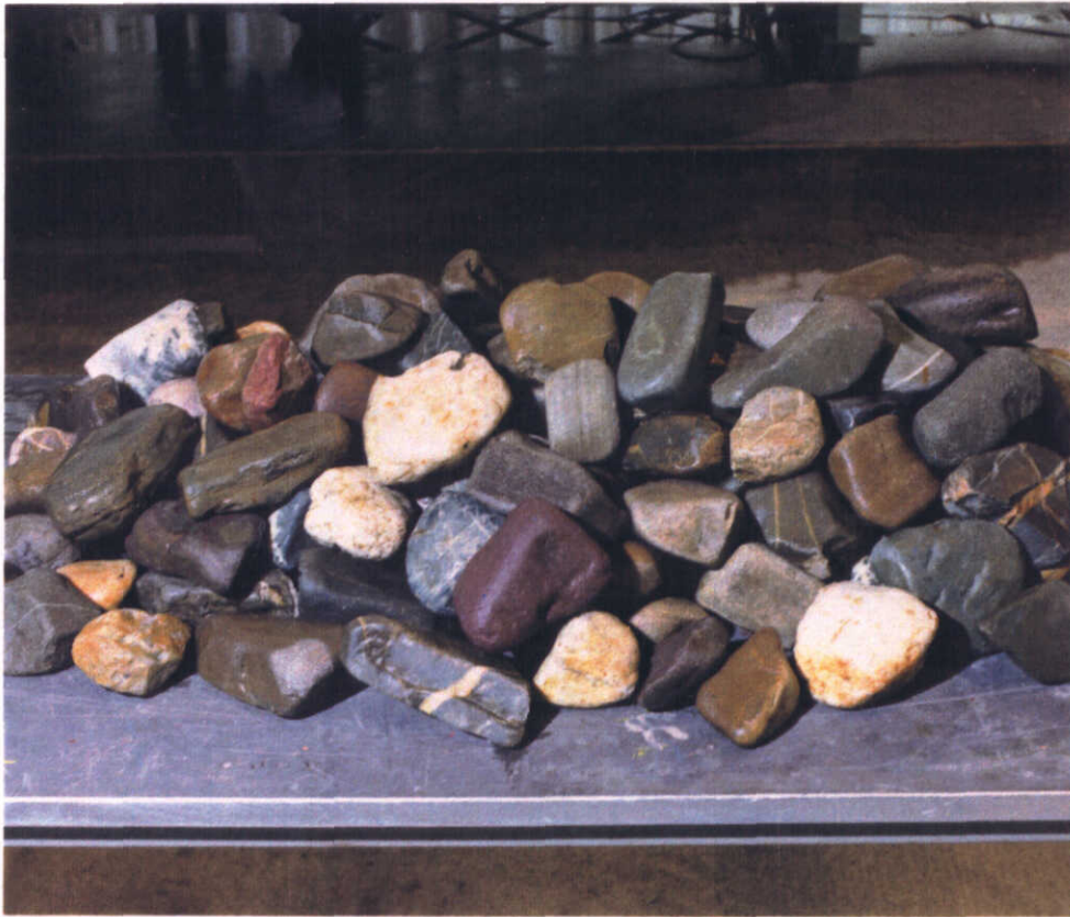
7. filterstenen met een diameter van ongeveer 65 mm
