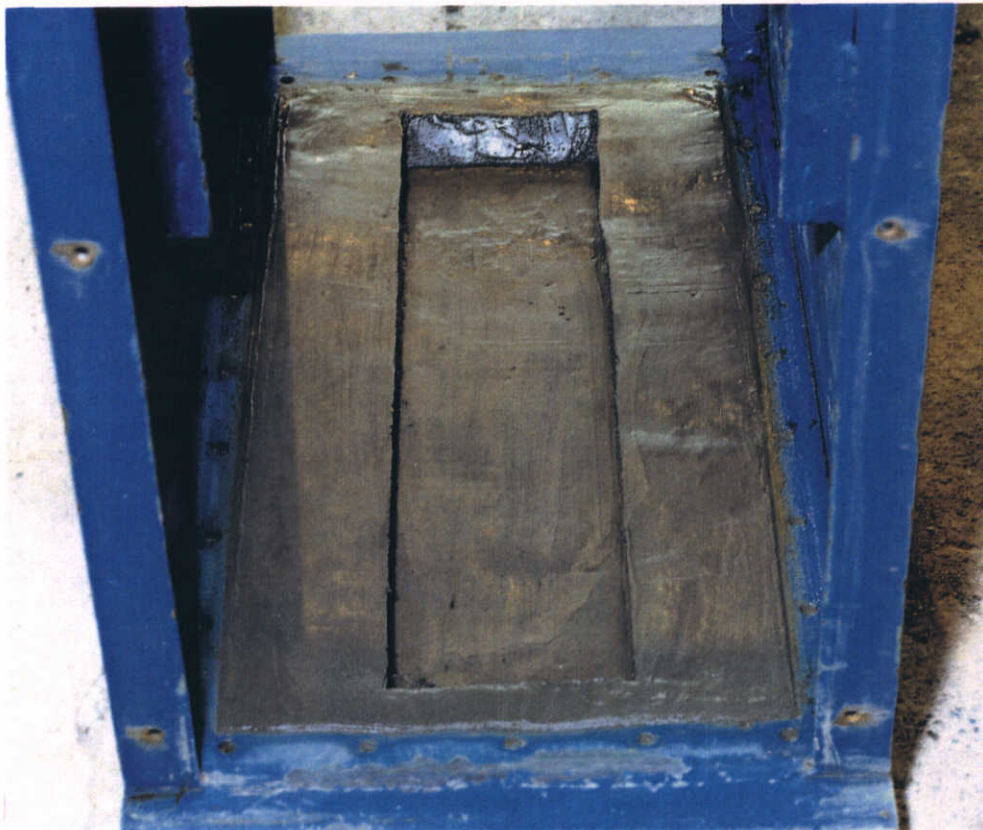
3. detail van de proefopstelling met een voorgevormde geul in de klei
