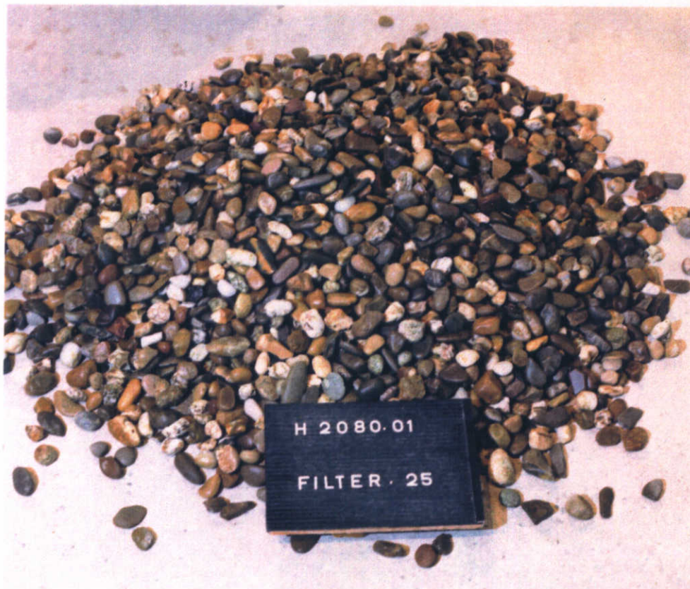
6. filterstenen met een diameter van ongeveer 25 mm
