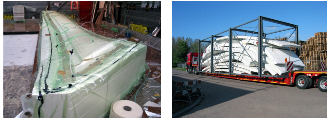
FIG. 7.13 Productieopname van de polyester schaal van een segment en de stapeling van transportabele segmenten in een transportcontainer voor het Rabin Center
