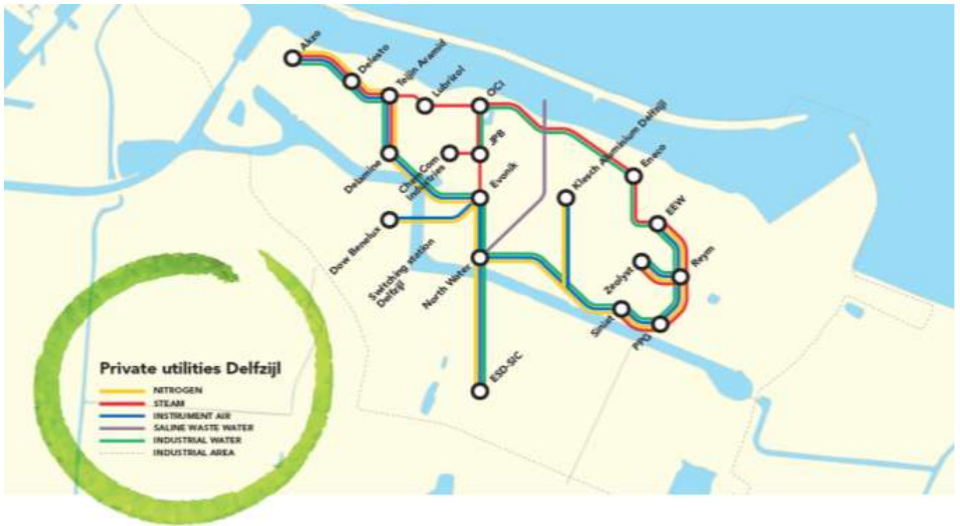
Figuur 11. Gezamenlijke utilities op het Chemie Park Delfzijl
