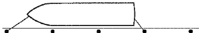
figure N.1 – alongside pier mooring system
