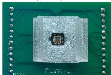
(d) QFN-packaged PCS chip in the socket
