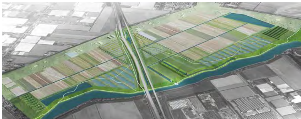
ILLUSTRATIE 8.10 Ontwerpexperiment Tweemanspolder. Het polderontwerp verenigt negotium en otium water. Het huidige gemaal is vervangen door de waterreeks - vaart, gemaal en uitlaat - die het polderwater ruimtelijk expliciet aan het boezemwater koppelt.
