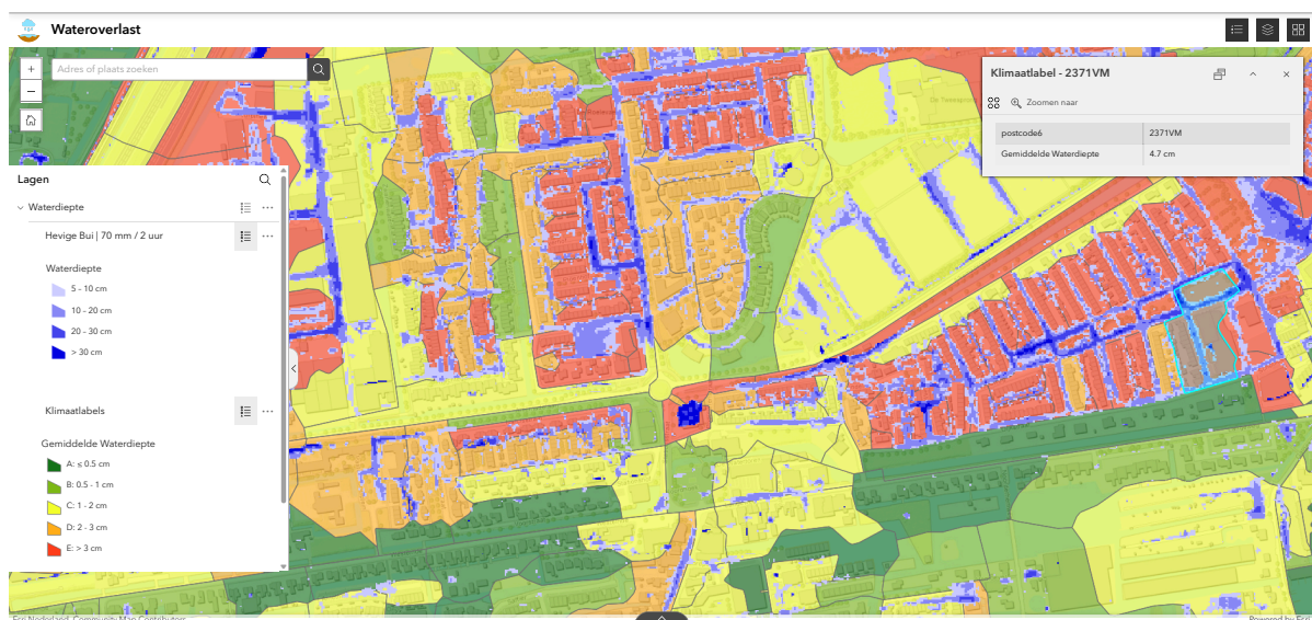
Figuur 6.2: Subpagina Wateroverlast van het klimaatlabdashboard, met de basislaag en klimaatlabellaag van de indicator Waterdiepte bij hevige bui weergegeven. Links is het lagenmenu zichtbaar, waarmee indicatoren en legenda's kunnen worden in- en uitgeschakeld. Rechts wordt een pop-upvenster getoond met postcode en gemiddelde waterdiepte.
