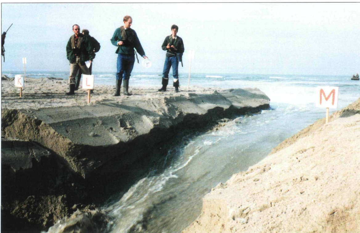
Figuur 4 Terugschrijdend talud in fase 2
