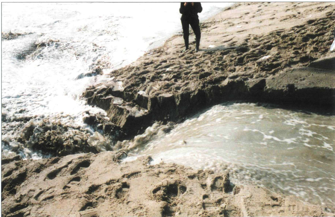
Figuur 3 Versteiling van het binnentalud tijdens fase 1
