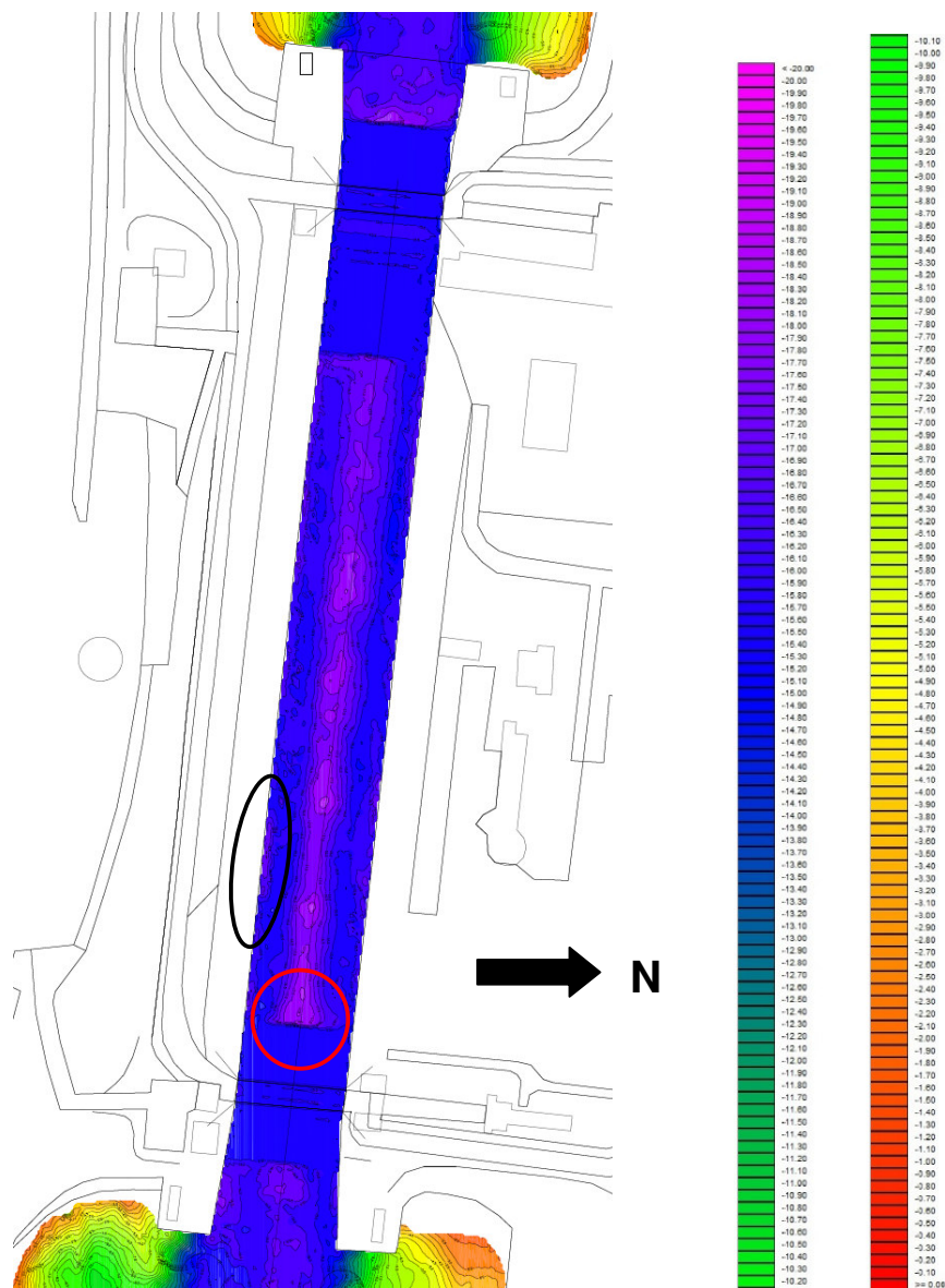
Figuur 24: Resultaten multibeammeting in de sluisolk (diepte in meter ten opzichte van NAP), 2011
