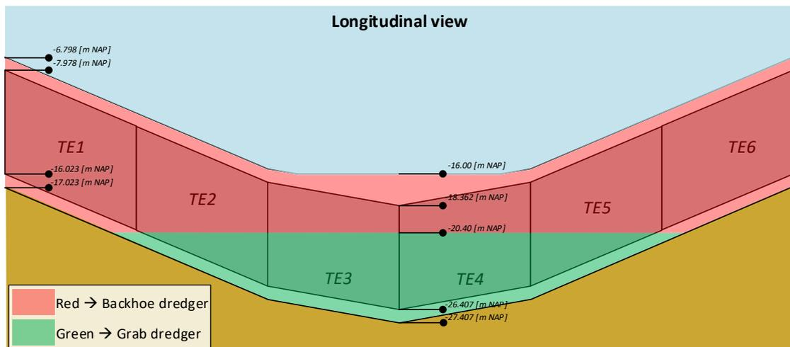
FIGURE 70, LONGITUDINAL DREDGING SCHEME; LONGITUDINAL VIEW
