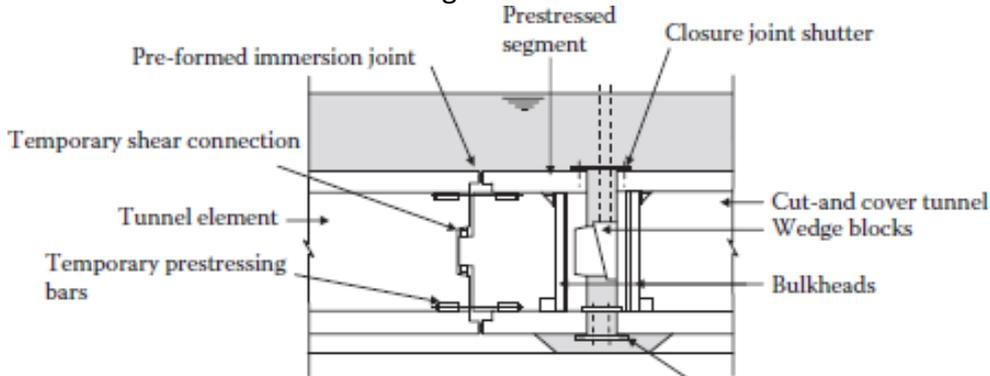
**FIGURE 41, PRESTRESSED SEGMENT CLOSURE JOINT (BABER & LUNISS, 2013)**
