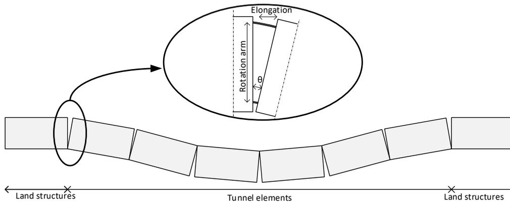
**FIGURE 34, IMMERSION JOINT ROTATION SITUATION SKETCH**
