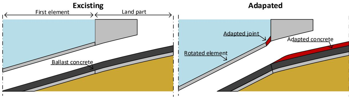
FIGURE 39, ADAPTED LAND HEAD; LONGITUDINAL VIEW
