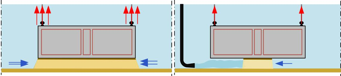
**FIGURE 31, BREAKING SOIL ADHESION VARIANTS (1/2) ; LONGITUDINAL VIEW**
