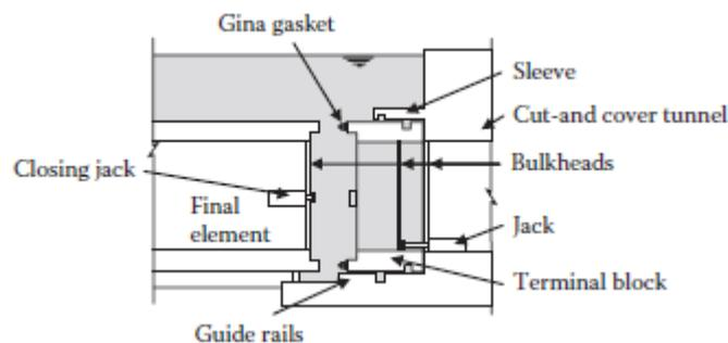
**FIGURE 42, TERMINAL BLOCK CLOSURE JOINT (BABER & LUNISS, 2013)**
