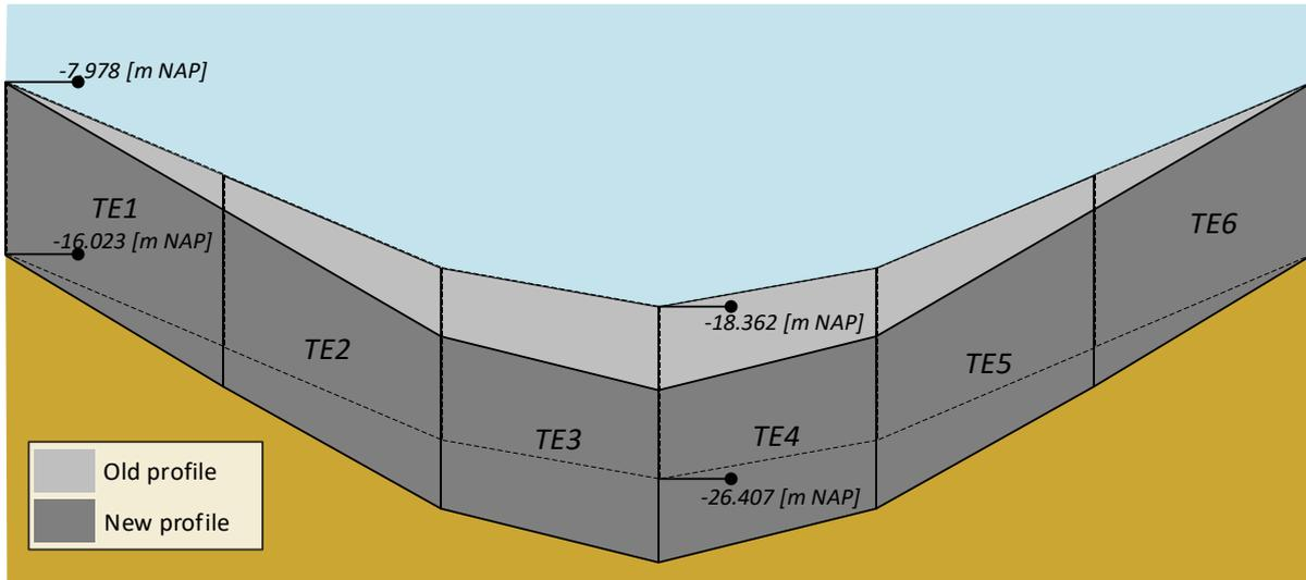
FIGURE 81, NEW TUNNEL ALIGNMENT; LONGITUDINAL VIEW
