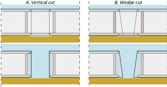
FIGURE 25, OPENING JOINT DESIGN SHAPE VARIANTS; ; LONGITUDINAL VIEW
