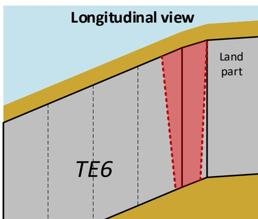
**FIGURE 72, OPENING JOINT; SIDE VIEW**
