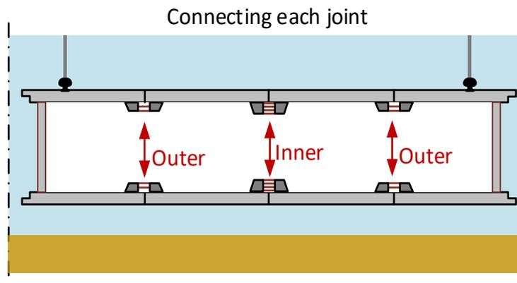
FIGURE 64, PRESTRESSING VARIANT 2 LAYOUT; LONGITUDINAL VIEW
