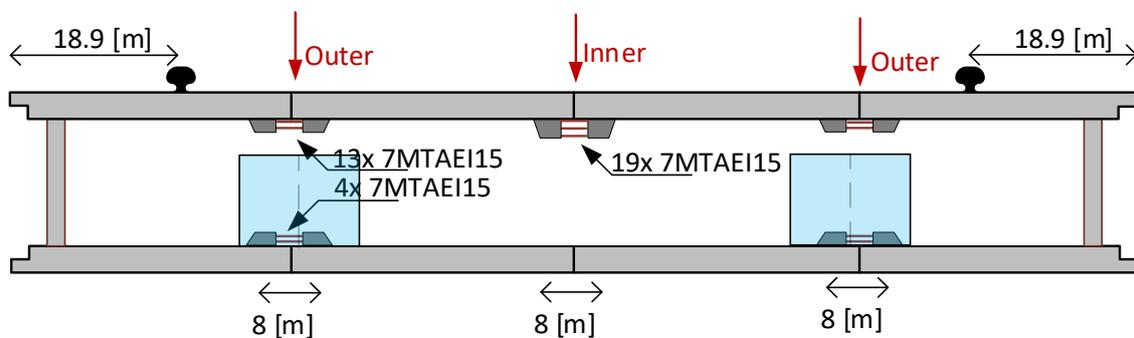
FIGURE 69, POST-TENSIONED PRESTRESSING LAY-OUT; LONGITUDINAL VIEW
