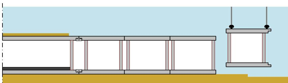
FIGURE 16, LIFTING SINGLE SEGMENT; LONGITUDINAL VIEW
