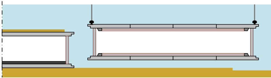
FIGURE 18, LIFTING SINGLE ELEMENT, INCLUDING PRESTRESSING; LONGITUDINAL VIEW
