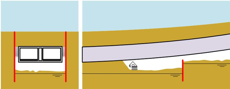
FIGURE 2, LOWERING TUNNEL BY DIGGING; SIDE VIEWS
