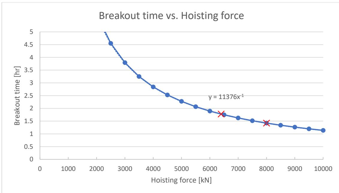
FIGURE 86, BREAKOUT TIME VS HOISTING FORCE
