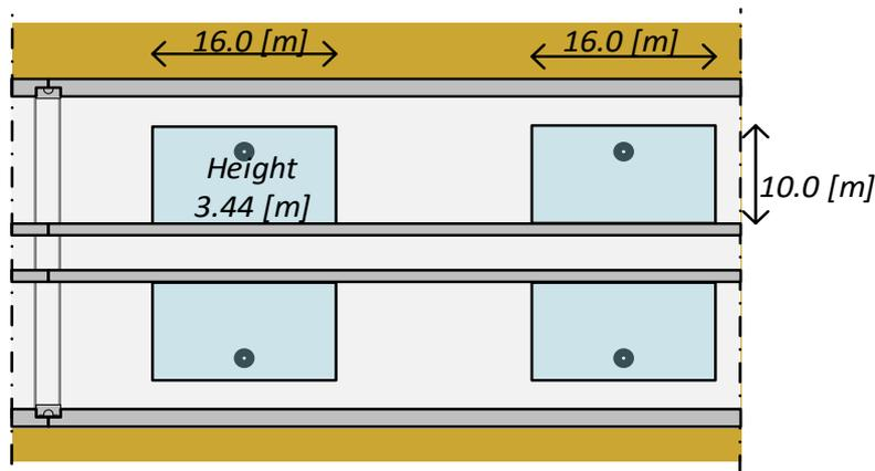
FIGURE 54, ACTUAL BALLAST TANKS LAY-OUT; TOP VIEW
