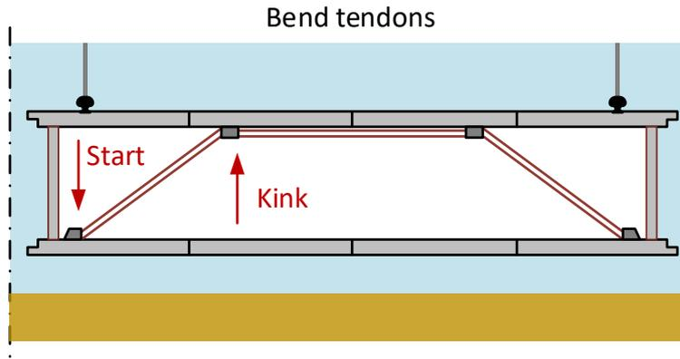
**FIGURE 65, PRESTRESSING VARIANT 3 LAYOUT; LONGITUDINAL VIEW**
