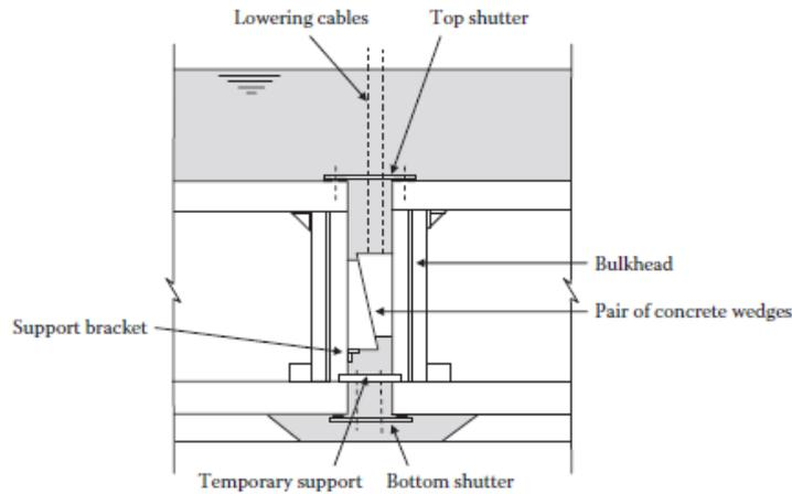
**FIGURE 40, CONCRETE IN-SITU CLOSURE JOINT (BABER & LUNISS, 2013)**
