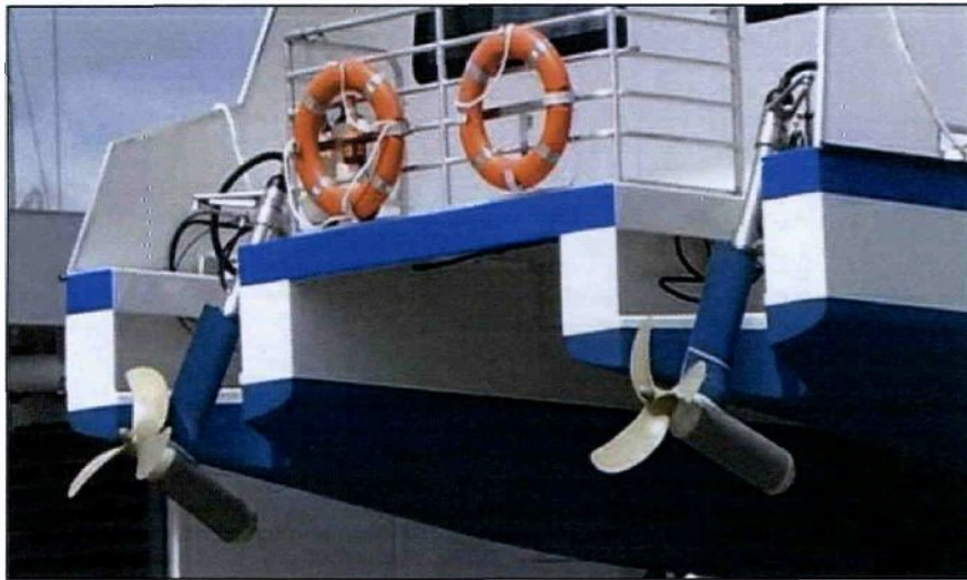
Figure 50: Système propulsif à pods
