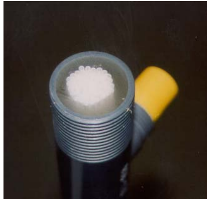
figuur 5.5.: Module met enkele tientallen capillairen
