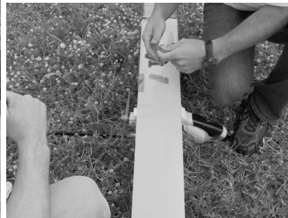
(d) Repairing trailing edge
