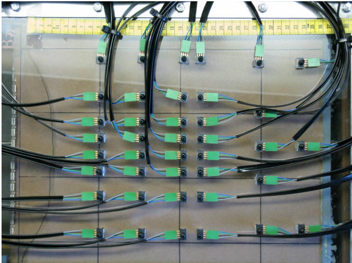
Figuur 7.4 Kanaalvorming t=110 minuten, kanaal bereikt opnemer 22 en 23 (proef B71b)(foto 1312)
