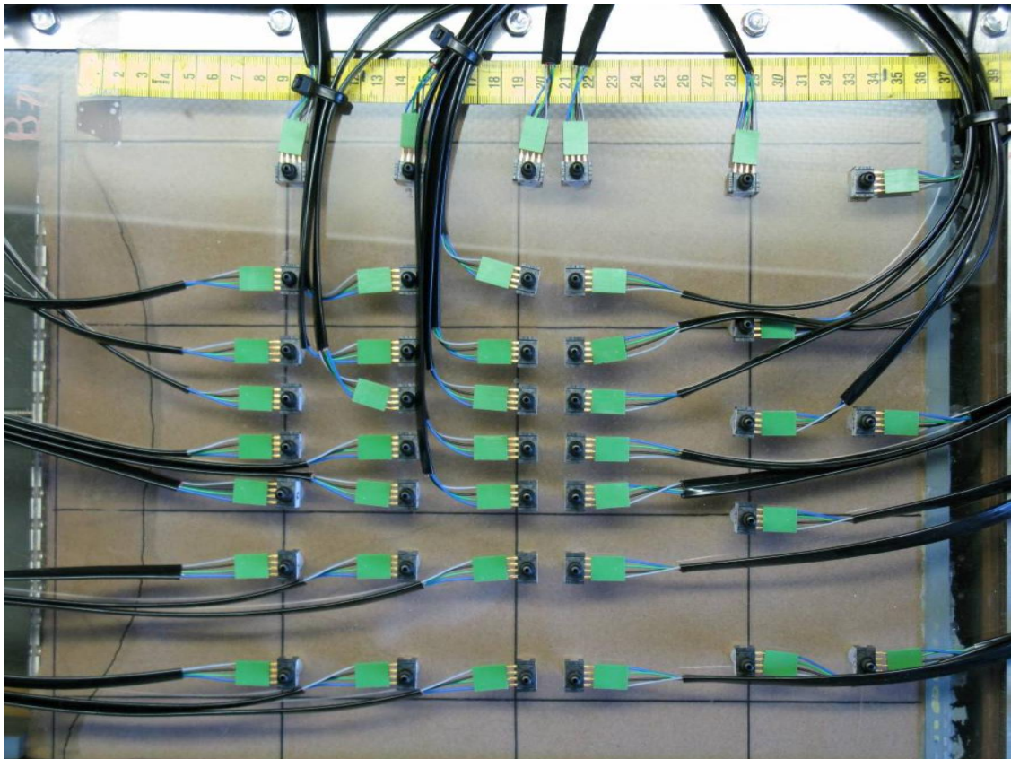
Figuur 4.15 Aangebrachte opnemers in de plaat
