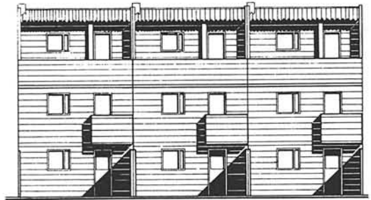
FACHADA POSTERIOR VIVIENDA TIPO A-1 Y B-1
