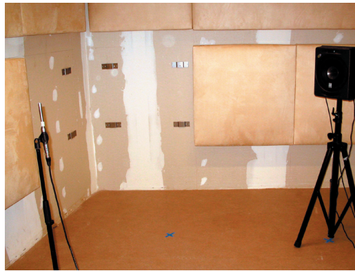
Figuur 4.5. TU-meetsysteem in testruimte van het leslokaal.
