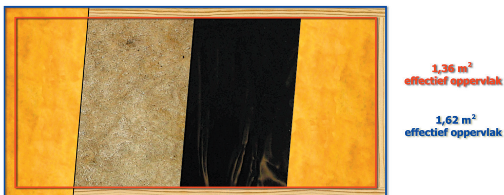
Figuur 3.6. Effectief oppervlak van het breedbandabsorptiepaneel.
