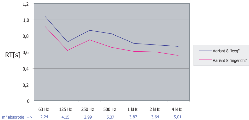
Figuur 4.19. Nagalmtijd van variant 8 "leeg" en "ingericht". Het verschil is omgerekend naar aantallen m^2 per octaafband.
