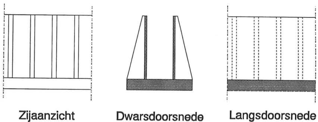
Figuur 3.3: Alternatief 2, een dunne vlakke wand in combinatie met steunberen.
