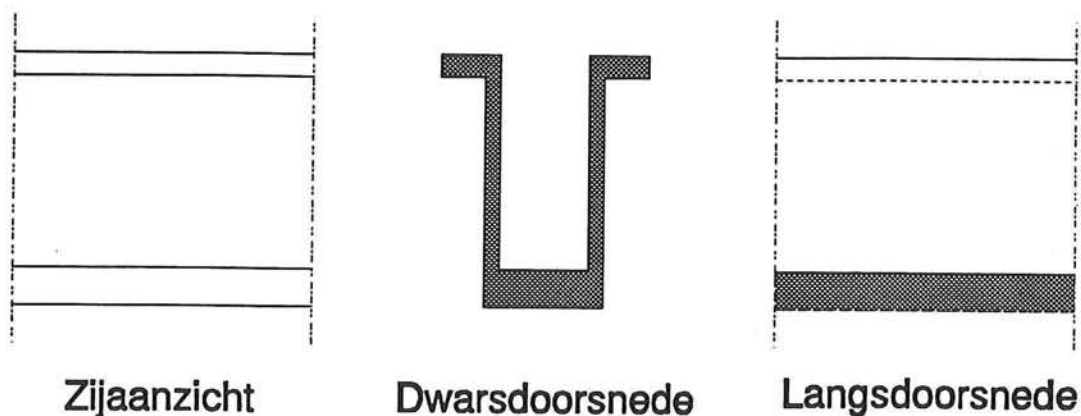
Figuur 3.4: Alternatief 3, een relatief dunne wand met aan de bovenzijde een randbalk.
