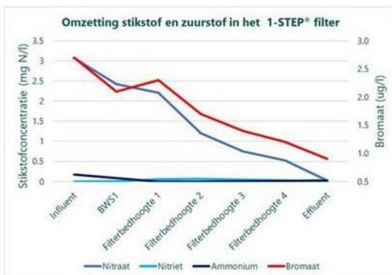
Afbeelding 3. Bromaat- ( \mu\text{g/l} ) en nitraatconcentraties ( \text{mg/l} ) over het filterbed (van bovenwaterstand tot effluent)
